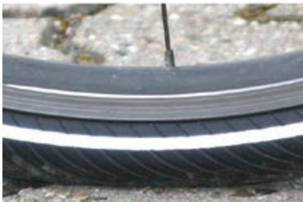
Afbeelding 96: Juiste vuldruk. De band is onder de belasting van het lichaamsgewicht nauwelijks vervormd
