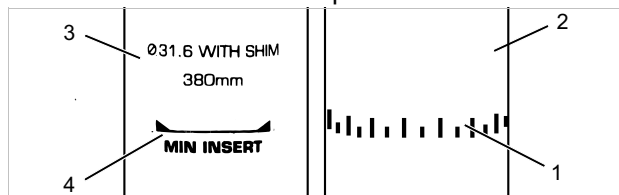
Afbeelding 85: Detailaanzicht zadelpen, voorbeelden van de markering van de minimale insteekdiepte
