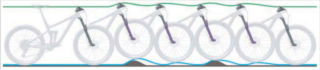
Afbeelding 215: Te snel uitveren van de verende voorvork
