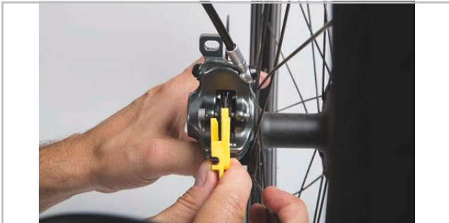
Afbeelding 201: Remvoering in gemonteerde toestand controleren met behulp van de transportbeveiliging
