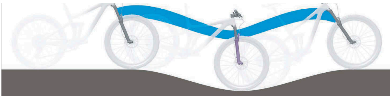
Illustration 16 : Comportement optimal de la fourche de suspension en terrain vallonné
