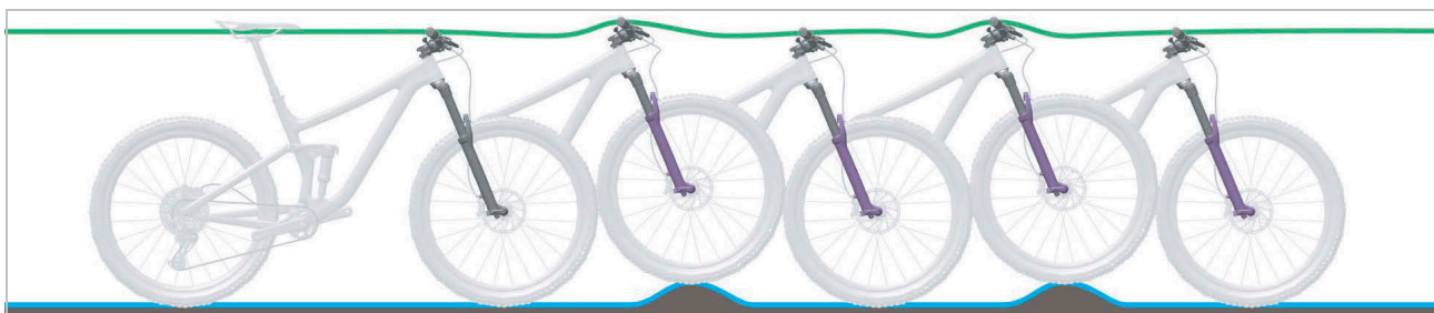
Illustration 15 : Comportement optimal de la fourche de suspension
