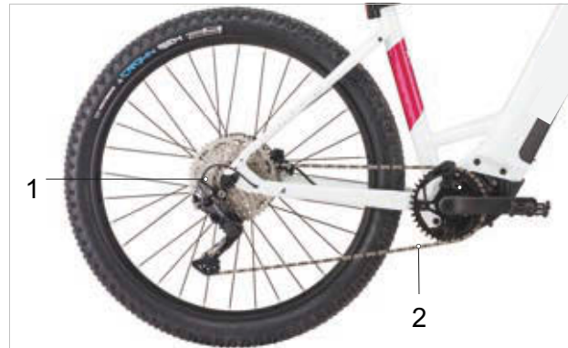
Illustration 45 : Schéma de l'entraînement à chaîne avec dérailleur
