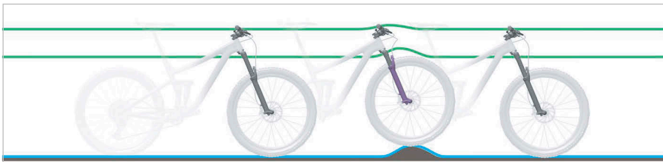
Illustration 17 : Comportement optimal de la fourche de suspension sur les irrégularités
