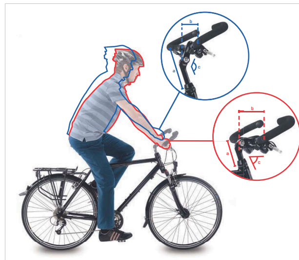
Illustration 117 : Position sur vélo de ville (en bleu) et sur vélo tout chemin (en rouge) avec modification de l'angle
