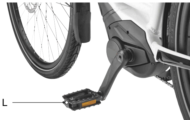
Illustration 94 : Pédale L dans le bras de manivelle gauche
