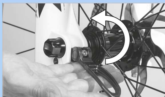
Illustration 84 : Enfoncez le levier d'attache rapide dans le sens de la flèche
