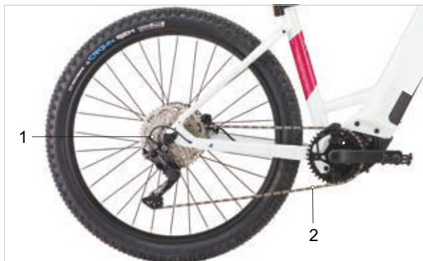
Illustration 33 : Schéma de l'entraînement à chaîne avec dérailleur
