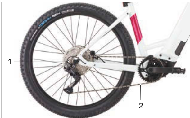
Illustration 28 : Schéma de l'entraînement à chaîne avec dérailleur
