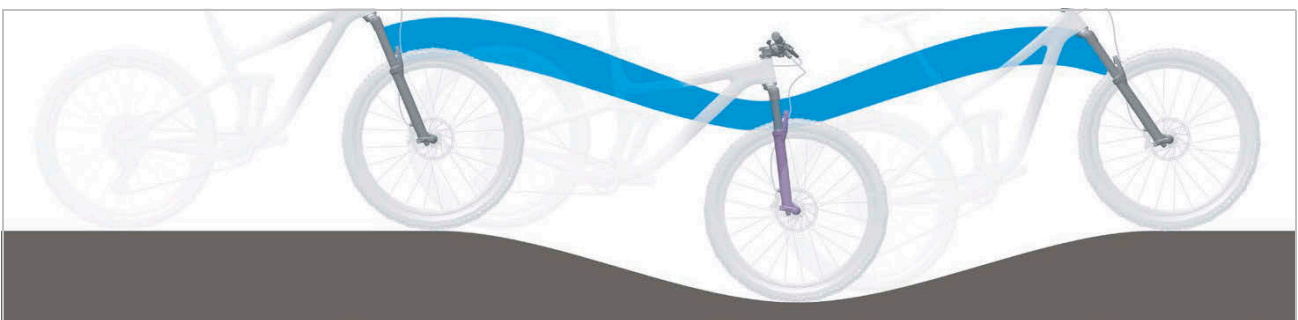
Illustration 15 : Comportement optimal de la fourche de suspension en terrain vallonné
