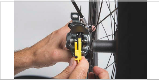
Illustration 178 : Contrôler la plaquette de frein montée à l'aide de la cale de transport
