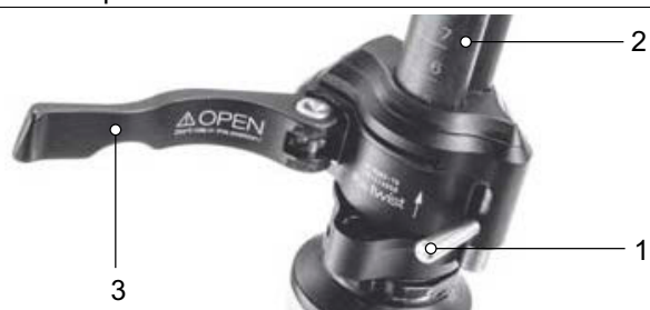
Illustration 65 : Levier de serrage ouvert de l'attache rapide de la potence (3) sur la potence (2), modèle I, avec levier de blocage sur la potence (1)
