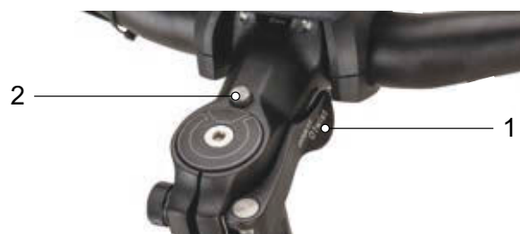
Illustration 66 : Potence, modèle II avec levier de serrage de l'attache rapide de la potence (1) et bouton de déblocage (2)
