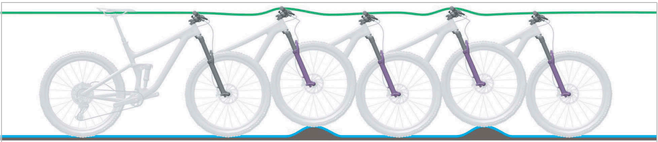
Illustration 14 : Comportement optimal de la fourche de suspension
