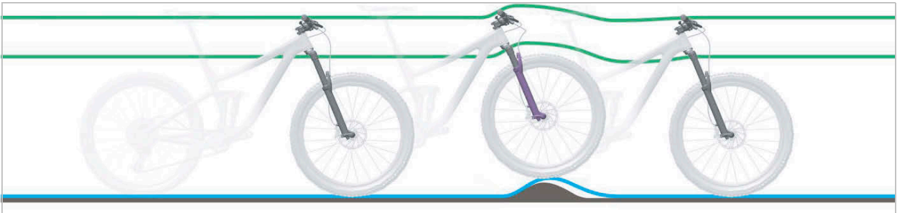
Illustration 220 : Amortissement trop dur de la fourche de suspension en cas d'irrégularités
