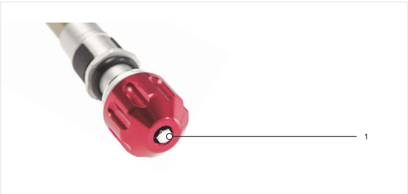
Illustration 218 : Exemple d'un réglage de détente SR SUNTOUR (fourche de suspension) (1)
