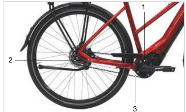
Illustration 29 : Schéma de l'entraînement à courroie
