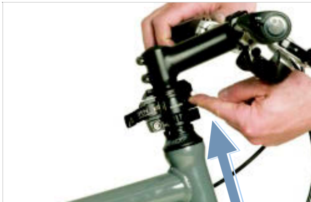
Illustration 151 : Pousser l'écrou de déverrouillage vers le haut
