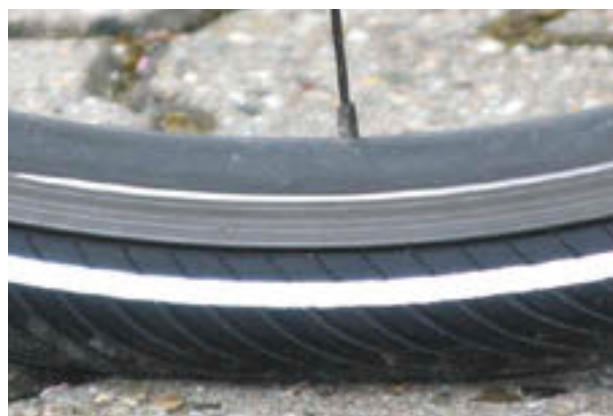
Illustration 85 : Pression correcte. Le pneu se déforme à peine sous le poids du corps.
