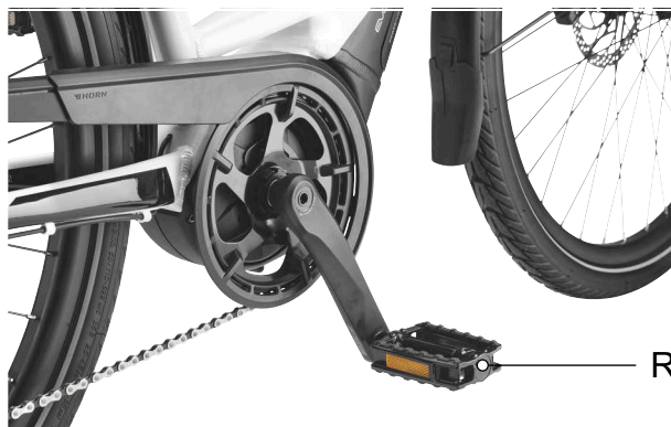
Illustration 69 : Pédale R dans le bras de manivelle droit
