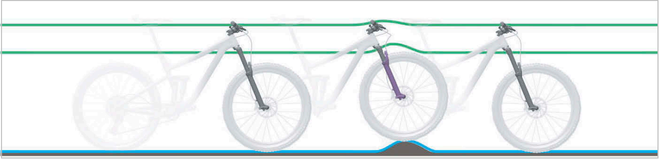
Illustration 16 : Comportement optimal de la fourche de suspension sur les irrégularités
