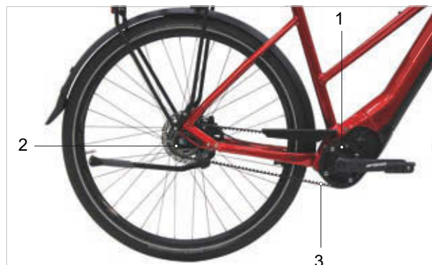
Illustration 34 : Schéma de l'entraînement à courroie
