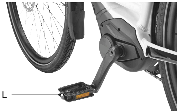
Illustration 68 : Pédale L dans le bras de manivelle gauche
