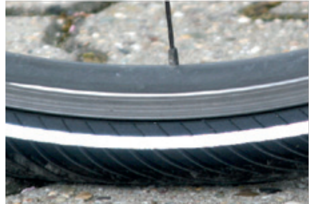
Abbildung 89: Korrekter Fülldruck. Der Reifen ist unter der Last des Körpergewichts kaum verformt
