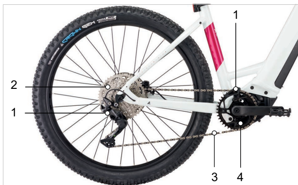
Abbildung 42: Schema Kettenantrieb mit Kettenschaltung
