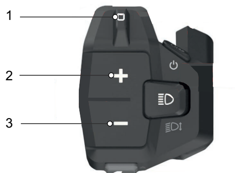
Abbildung 105: Lage Navigation Wippe (1), Plus- (2) und Minus (3) Taster
