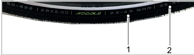
Abbildung 135: Angabe Fülldruck in bar (1) und psi (2)
