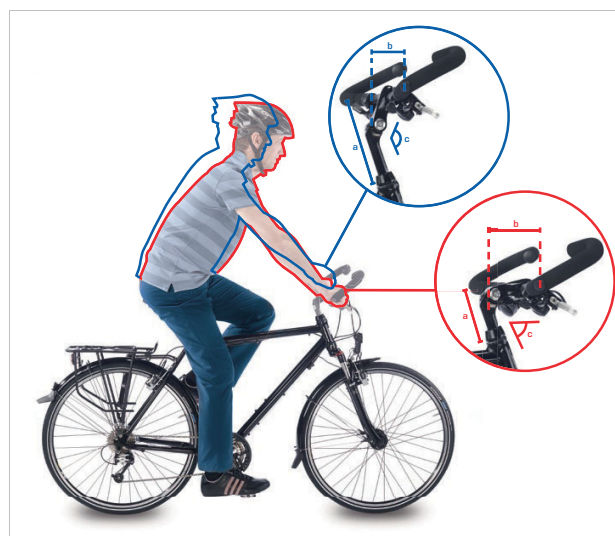
Abbildung 87: Citybike (blau) und Trekkingrad Position (rot) durch Winkeländerung
