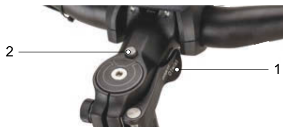
Figur 77: Frempind, udførelse II med greb på frempindens hurtigbespænding (1) og frigørelsesknapp (2)
