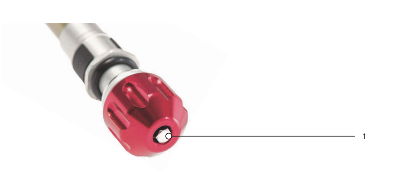
Figur 218: Eksempel på SR SUNTOUR-trækindstillingsanordning (fjedergaffel) (1)
