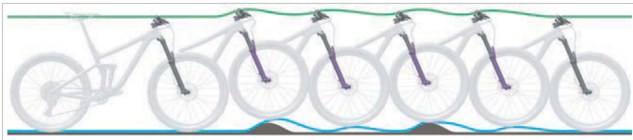
Figur 215: Fjedergaflen fjedrer for hurtigt tilbage
