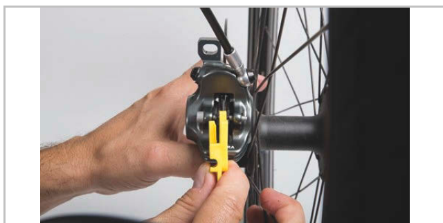
Figur 201: Kontrol af bremsebelægning i indbygget tilstand vha. transportsikringen
