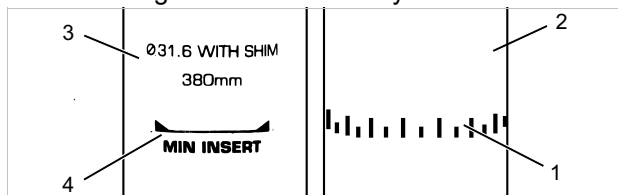
Figur 85: Detaljeret visning af sadelpind, eksempler på markering af minimumsdybden
