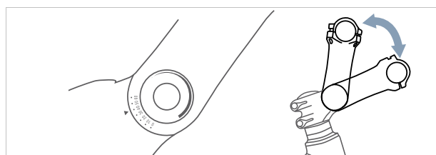
Figur 93: Forskellige versioner af vinkeljusterbare frempinde
