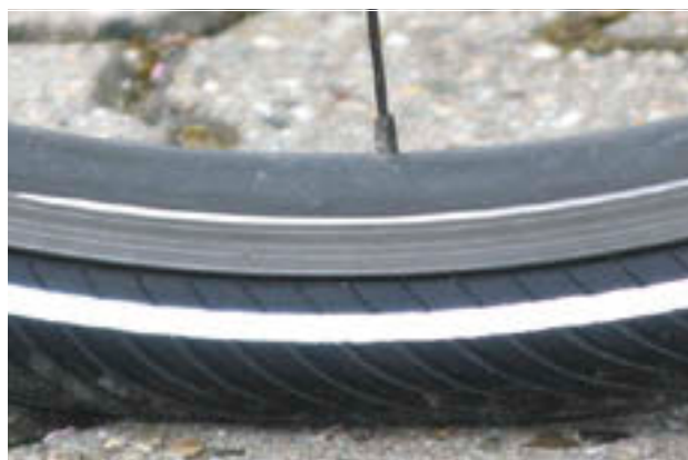
Figur 96: Korrekt dæktryk. Dækkets form er næsten ikke ændret af kropsvægtens belastning
