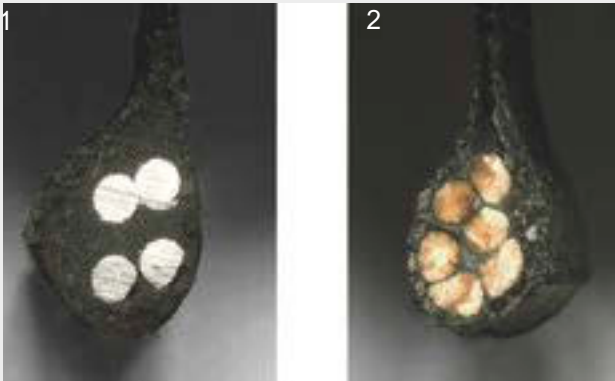
Figur 26: Stålkerner (1) og kevlarkerner (2)
