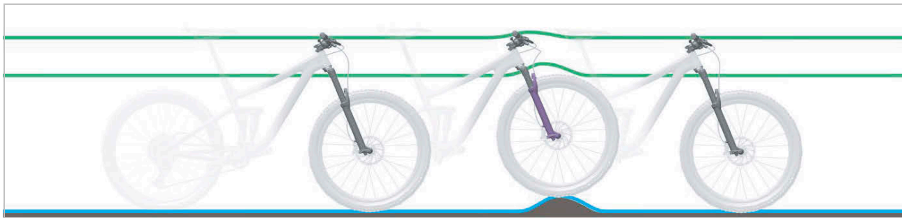
Figur 16: Fjedergaflens optimale køremåde ved ujævnheder
