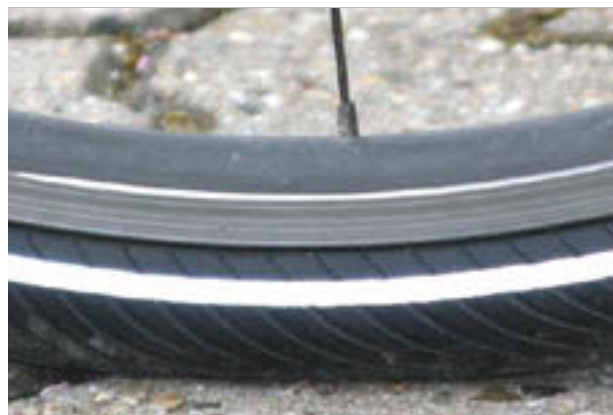
Figur 119: Korrekt dæktryk. Dækkets form er næsten ikke ændret af kropsvægtens belastning
