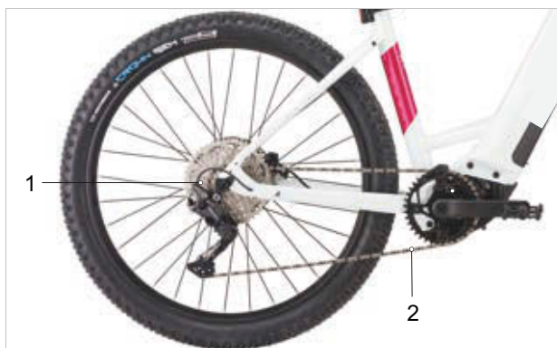
42. ábra: Külső váltóval felszerelt láncajtás vázlata
