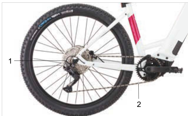
47. ábra: Külső váltóval felszerelt lánchajtás vázlata
