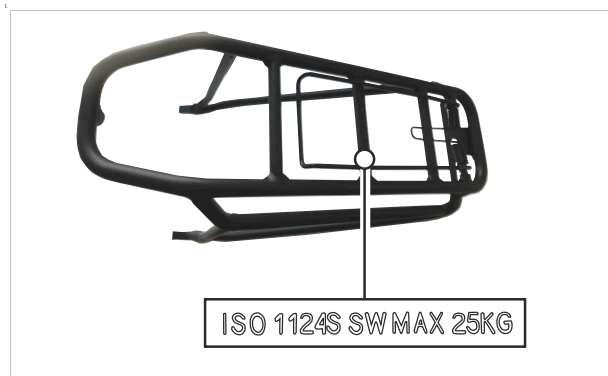
176. ábra: A csomagtartón fel van tüntetve maximális teherbírása (1)
