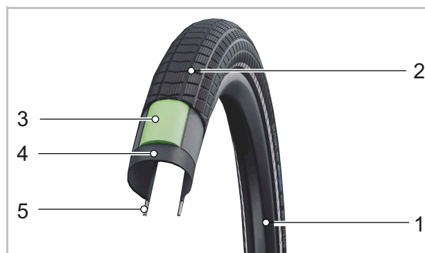
25. ábra: Nyitott gumiabroncsok felépítése
