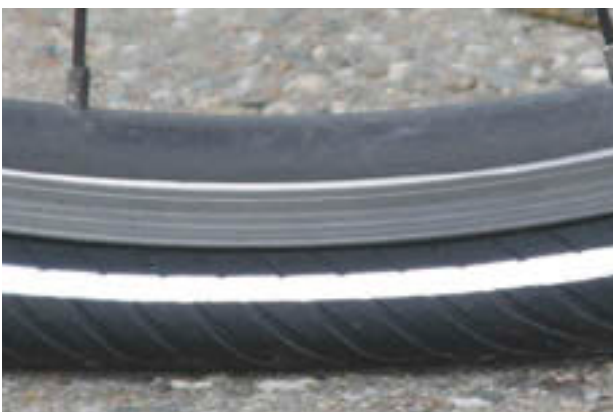
97. ábra: Túlontúl alacsony guminyomás
