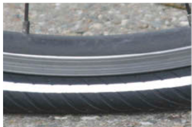
120. ábra: Túlontúl alacsony guminyomás
