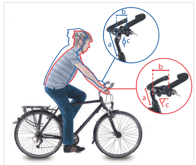
117. ábra: Városi kerékpár (kék) és túrakerékpár (piros) a szög változtatásával
