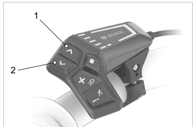
183. ábra: A fényerő növelése gomb (2) és fényerő csökkentése gomb (1) elhelyezkedése
