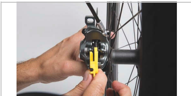
201. ábra: Fékbetét ellenőrzése beépített állapotban a szállítási rögzítés segítségével
