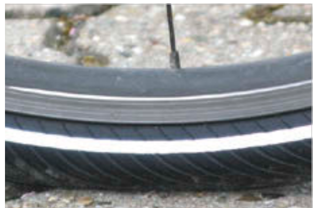
119. ábra: Helyes guminyomás. A gumiabroncs alakja a testsúly terhe alatt alig változik
