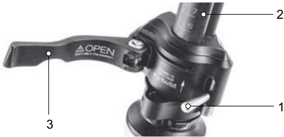
76. ábra: A kormányzár-gyorszár (3) nyitott gyorskioldója a kormányzáron (2), I kivitel, a kormányzáron (1) lévő rögzítőkarral
