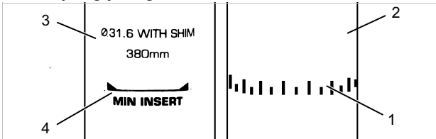
85. ábra: Nyeregcsövek részletes nézete, példák a legkisebb betolási mélység jeléhez
