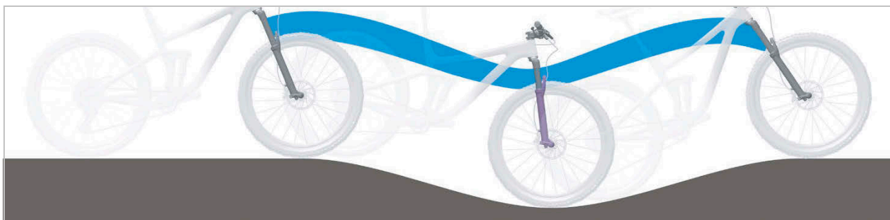
15. ábra: A teleszkópos villa optimális menetviselkedése dombos terepen
