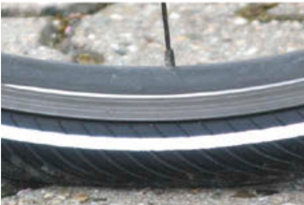
96. ábra: Helyes guminyomás. A gumiabroncs alakja a testsúly terhe alatt alig változik
