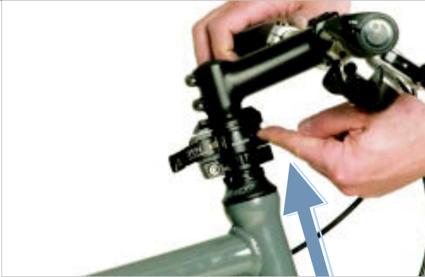
172. ábra: A reteszoldó csap felfelé nyomása
