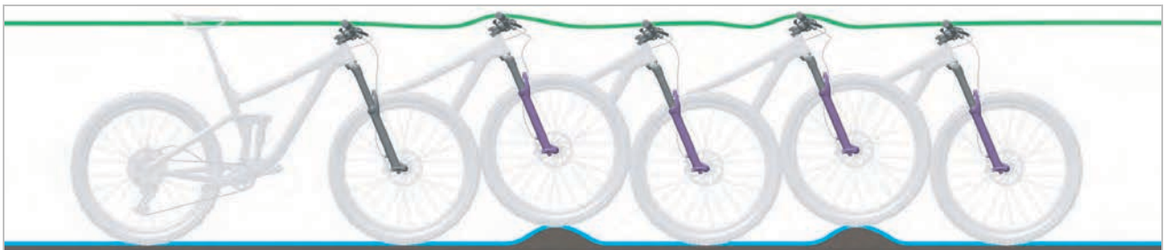
Abbildung 17: Optimales Fahrverhalten der Federgabel
