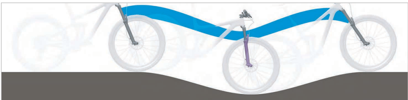
Abbildung 15: Optimales Fahrverhalten der Federgabel im hügeligen Gelände
