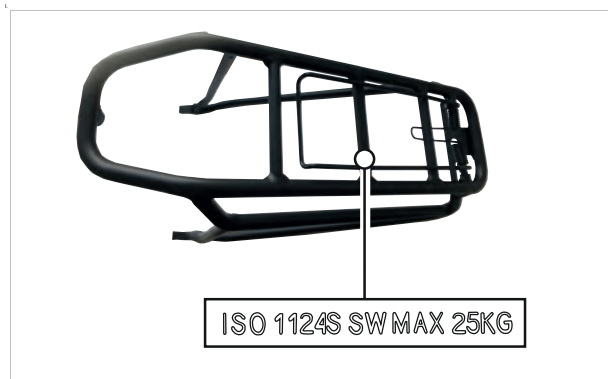
Abbildung 174: Auf dem Gepäckträger ist seine maximale Tragfähigkeit (1) ausgewiesen
