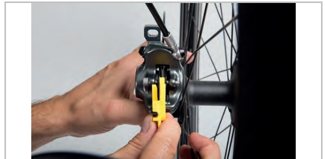
Abbildung 199: Bremsbelag im eingebauten Zustand mithilfe der Transportsicherung prüfen
