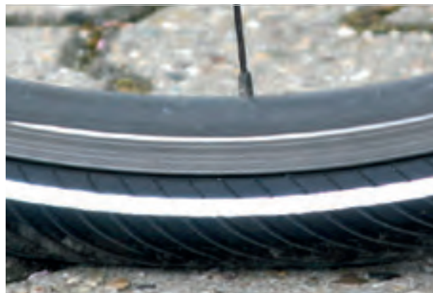
Abbildung 117: Korrekter Fülldruck. Der Reifen ist unter der Last des Körpergewichts kaum verformt
