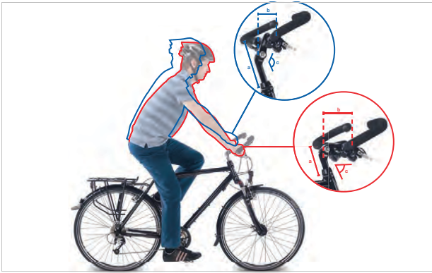
Abbildung 92: Citybike (blau) und Trekkingrad Position (rot) durch Winkeländerung
