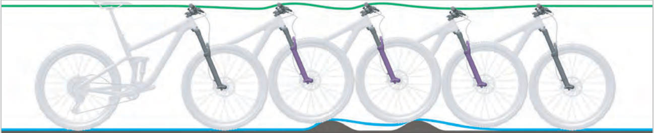
Abbildung 215: Zu langsames Ausfedern der Federgabel
