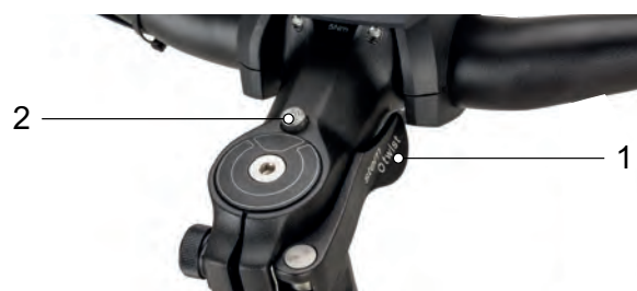
Abbildung 75: Vorbau, Ausführung II mit Spannhebel des Vorbau-Schnellspanners (1) und Entsperrknopf (2)
