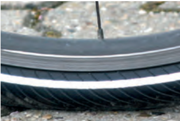
Abbildung 94: Korrekter Fülldruck. Der Reifen ist unter der Last des Körpergewichts kaum verformt
