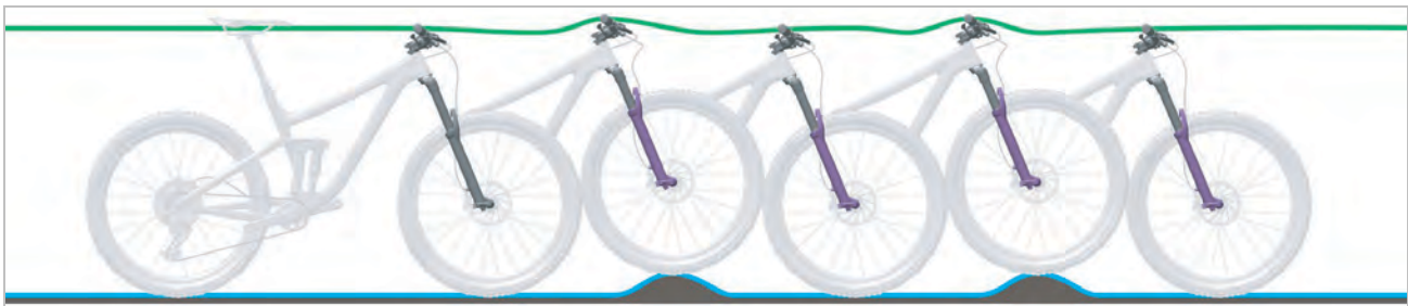
Abbildung 14: Optimales Fahrverhalten der Federgabel
