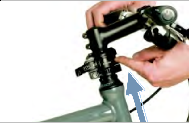
Abbildung 170: Entriegelungsbolzen nach oben drücken
