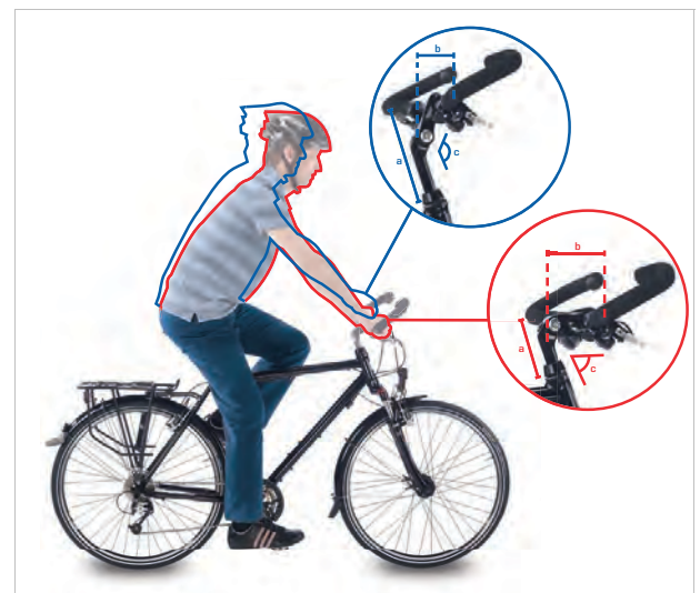
Abbildung 115: Citybike (blau) und Trekkingrad Position (rot) durch Winkeländerung
