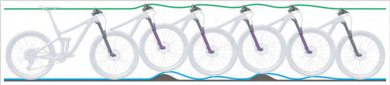
Abbildung 213: Zu schnelles Ausfedern der Federgabel
