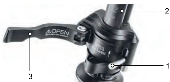
Abbildung 74: Geöffneter Spannhebel des Vorbau-Schnellspanners (3) am Vorbau (2), Ausführung I, mit Sicherungshebel am Vorbau (1)
