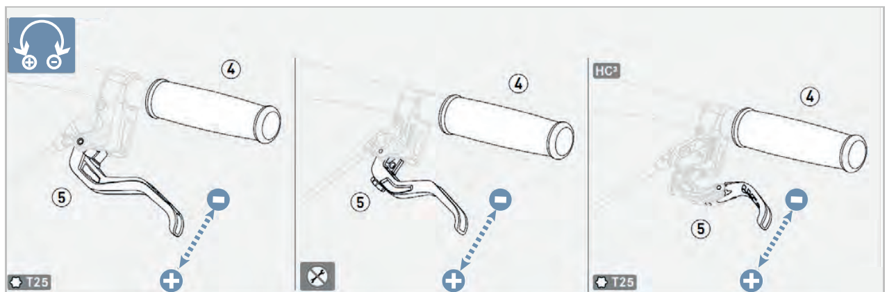
Abbildung 123: Griffweite Handbremse MAGURA Scheibenbremse einstellen
