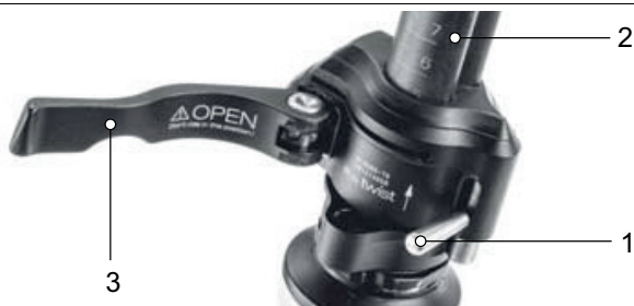
Abbildung 91: Geöffneter Spannhebel des Vorbau-Schnellspanners (3) am Vorbau (2), Ausführung I, mit Sicherungshebel am Vorbau (1)
