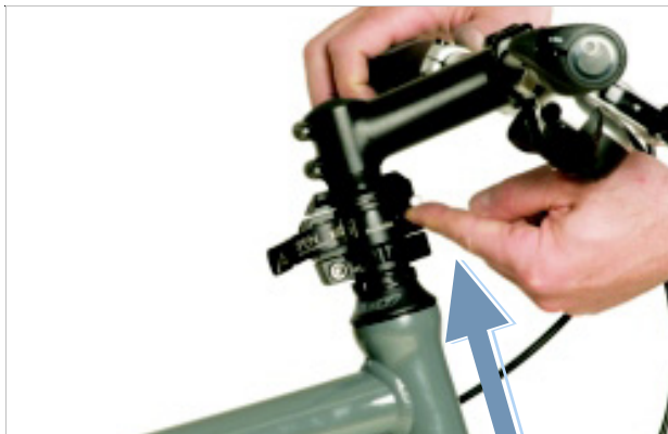
Abbildung 156: Entriegelungsbolzen nach oben drücken
