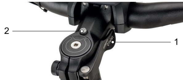
Abbildung 92: Vorbau, Ausführung II mit Spannhebel des Vorbau-Schnellspanners (1) und Entsperrknopf (2)
