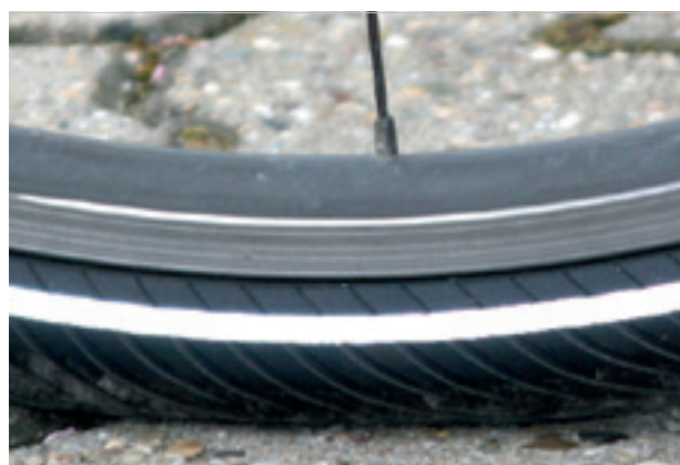
Abbildung 119: Korrekter Fülldruck. Der Reifen ist unter der Last des Körpergewichts kaum verformt
