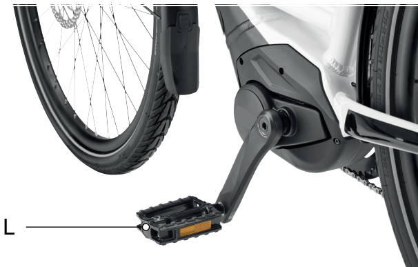
Abbildung 94: L Pedal im linken Kurbelarm
