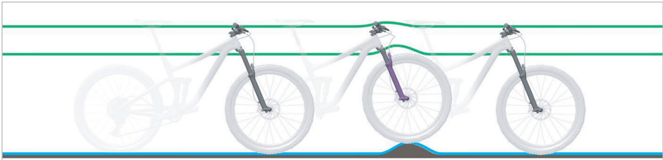
Abbildung 17: Optimales Fahrverhalten der Federgabel bei Unebenheiten
