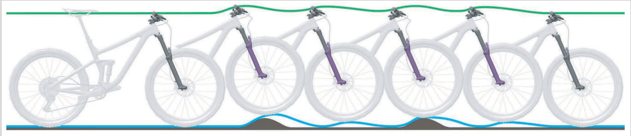
Abbildung 217: Zu schnelles Ausfedern der Federgabel
