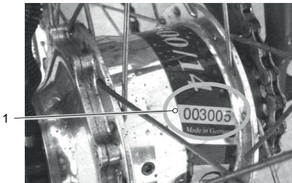
Abbildung 129: Seriennummer ROHLOFF Speedhub 500/14
