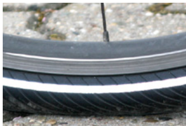
Figur 67: Korrekt dæktryk. Dækkets form er næsten ikke ændret af kropsvægtens belastning
