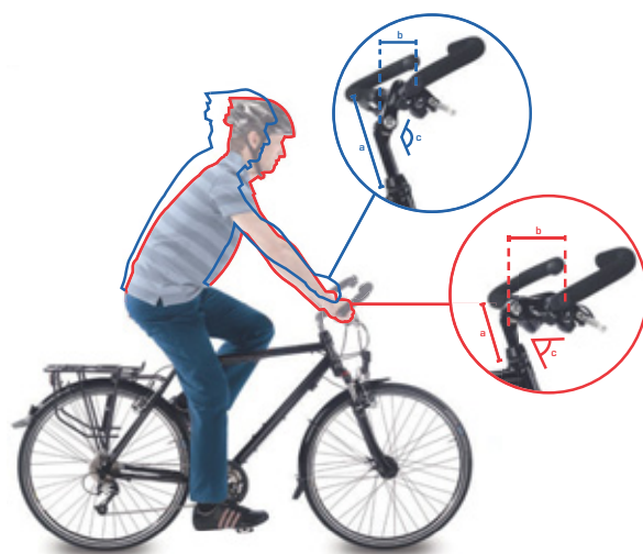
Figur 65: Position for citybike (blå) og trekkingcycel (rød) med vinkelændring
