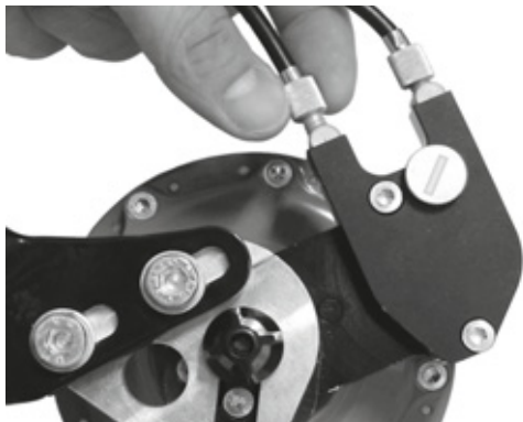
Figur 121: På udgaver af ROHLOFF-nav med ekstern skifteaktivering sidder kabelindstilleren på wireboksen, som sidder på venstre side
