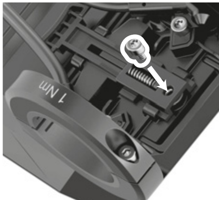
Figur 79: Indskruining af blokeringsskrue
