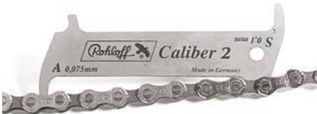
Figura 134: Ejemplo de calibre de medición ROHLOFF
