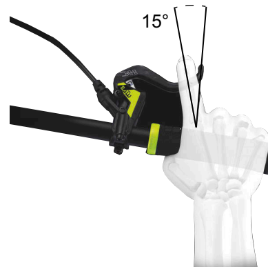
Figura 81: Posición del freno de mano
