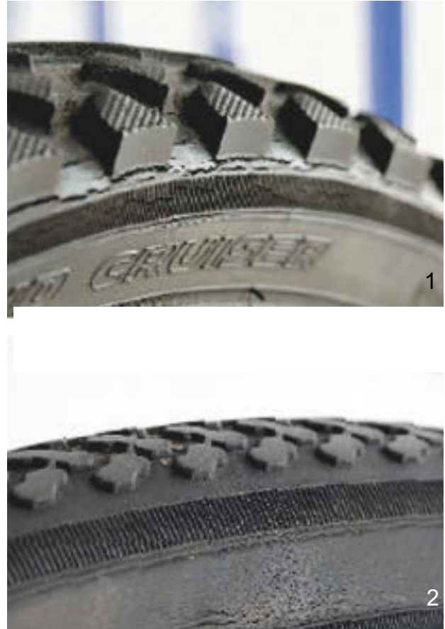
Figura 128: Ejemplos de fisuras por fatiga (1) y fisuras por envejecimiento (2)
