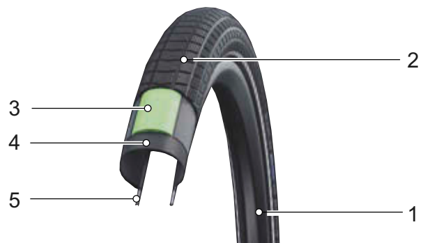
Figura 11: Estructura de las cubiertas abiertas
