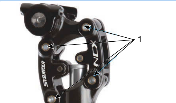
Figura 159: Puntos de lubricación de la tija de sillín de muelle SR SUNTOUR
