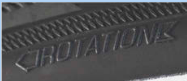
Figura 50: Flecha de sentido de la marcha
