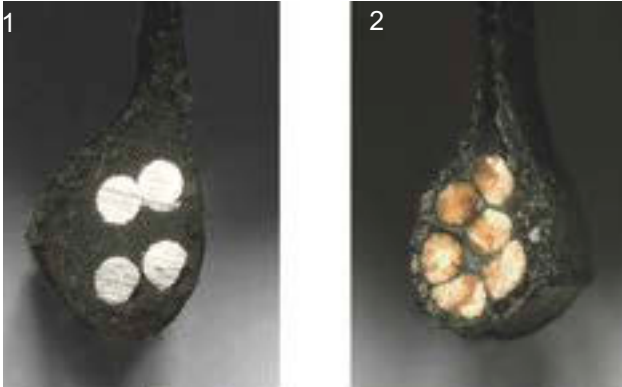
Figura 12: Núcleo de acero (1) y núcleo de Kevlar (2)
