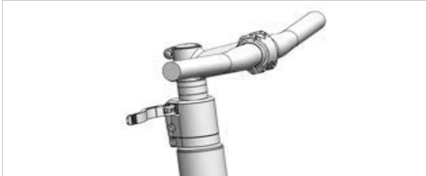
Figura 119: Ejemplo de All Up con palanca tensora de la potencia abierta
