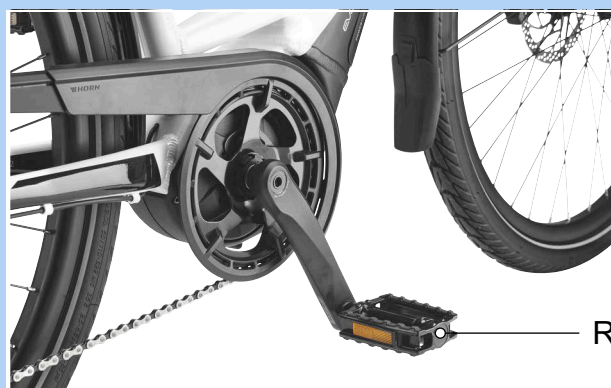
Figura 54: Pedal R en el brazo de manivela derecho
