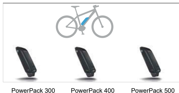
Figura 34: Vista general de la batería en el cuadro
