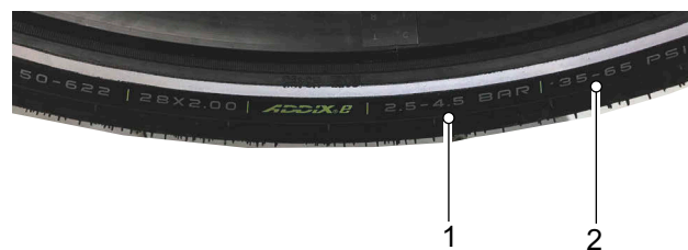
Figura 126: Indicación de presión de inflado en bar (1) y psi (2)
