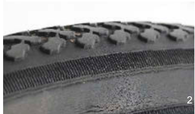
Figur 128: Eksempler på svækkelsesrevner (1) og ældningsrevner (2)
