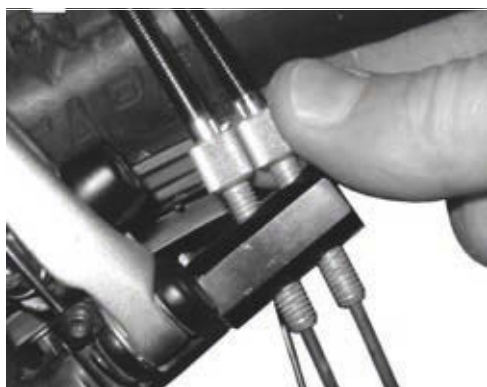
Figur 153: På udgaver af ROHLOFF-nav med intern skifteaktivering sidder kabelindstilleren på kabelmodholdet
