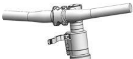
Figur 107: Eksempel All Up med løsnet frempindsgreb
