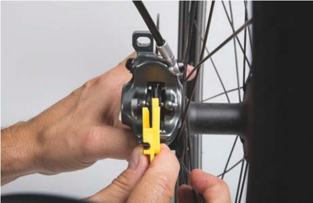
Figur 129: Kontrol af bremsebelægning i indbygget tilstand vha. transportsikringen
