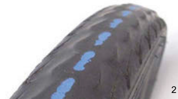
Figur 127: Dæk uden profil, som kan udskiftes (1), og dæk, hvor punkteringsbeskyttelsen (2) kan ses gennem slidbanen, og som skal udskiftes
