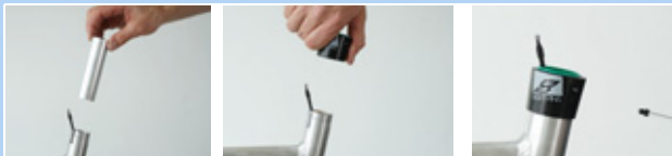
Figur 174: Montering af glidebøsning og udvendig kappe
