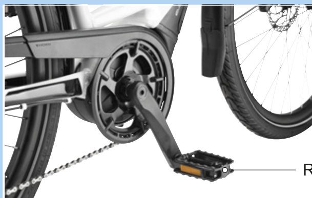
Figur 46: R-pedal i højre pedalarm
