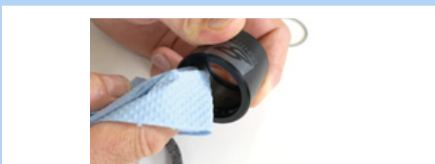
Figur 164: Rengøring af udvendig kappe
