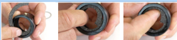
Figur 165: Ilægning af filtrering
