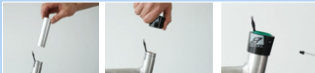
Figur 141: Montering af glidebøsning og udvendig kappe
