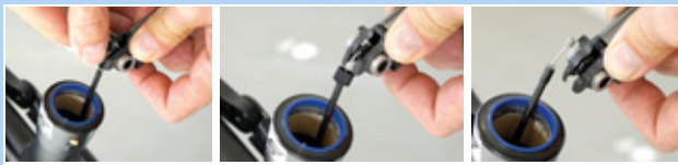
Figur 158: Fjernelse af bowdenkabel
