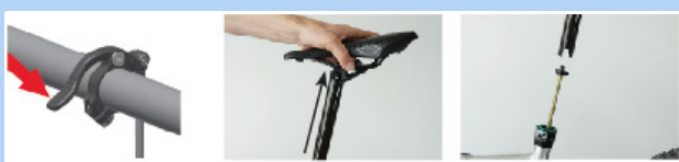
Figur 118: Udtrækning af sadelpind
