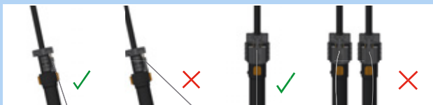
Figur 144: Korrekt og forkert bowdenkabel
