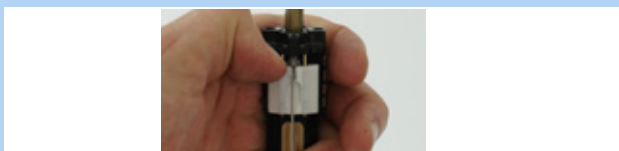
Figur 143: Den hvide aktiveringsskyder skubbes nedad
