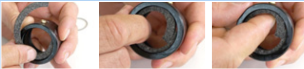
Illustration 124 : Insérer l'anneau de feutre
