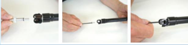
Illustration 130 : Fixer le couvercle de valve de la cartouche
