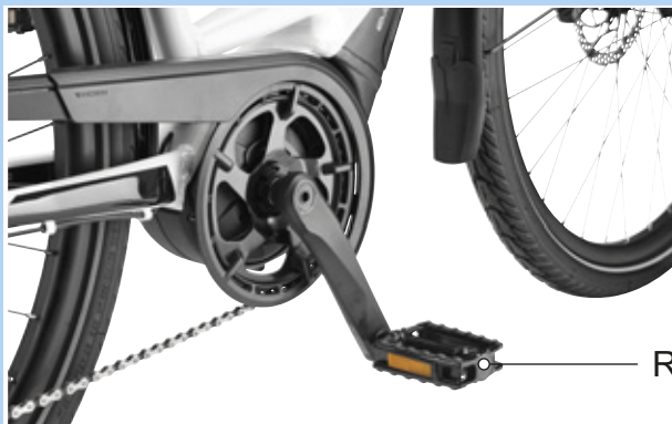
Illustration 41 : Pédale R dans le bras de manivelle droit
