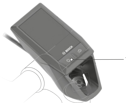
Illustration 85 : Position de la touche Marche/Arrêt (unité de commande)
