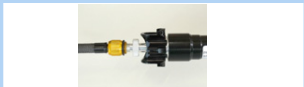
Illustration 129 : Pomper de l'air dans la cartouche
