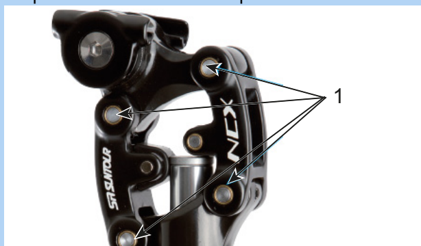
Illustration 110 : Points de lubrification de la tige de selle suspendue SR Suntour
