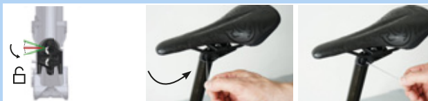
Illustration 111 : Placer le mécanisme de réglage de la hauteur en « position ouverte »
