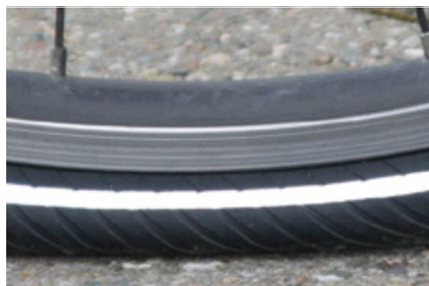
72. ábra: Túlontúl alacsony töltőnyomás
