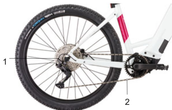
19. ábra: Külső váltóval felszerelt lánchajtás vázlata
