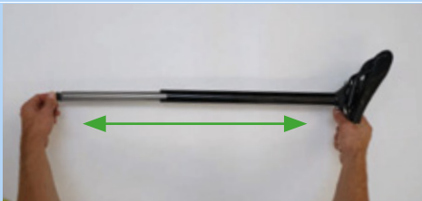
167. ábra: Nyeregcső széthúzása
