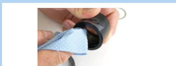
127. ábra: Külső hüvely tisztítása
