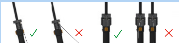
142. ábra: Helyesen és hibásan beállított bovdent
