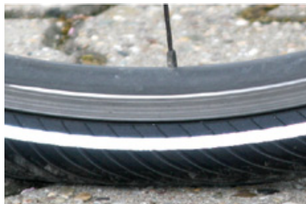
71. ábra: Helyes töltőnyomás. A gumiabroncs alakja a testsúly terhe alatt alig változik
