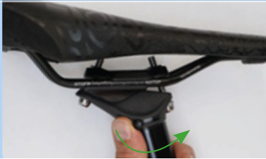
166. ábra: Magasságállítás nyitása
