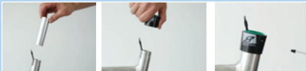
172. ábra: Siklópersely és külső hüvely beépítése
