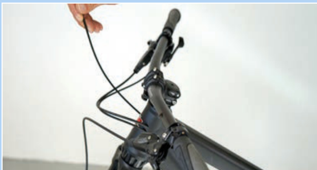
174. ábra: Végsapka beakasztása
