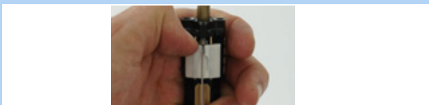
141. ábra: Fehér működtető kapcsoló lefelé tolása
