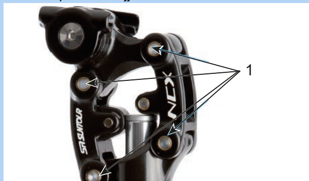
114. ábra: SR kenőpontok Suntour rugós nyeregcső
