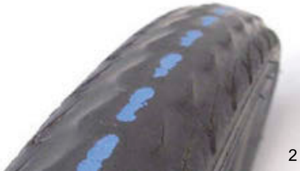
Afbeelding 127: Een band zonder profiel, die kan worden vervangen (1) en een band met zichtbare lekbescherming (2), die moet worden vervangen
