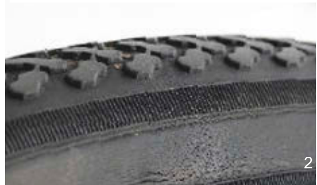
Afbeelding 128: Voorbeelden van vermoeiingsscheuren (1) en verouderingsscheuren (2)
