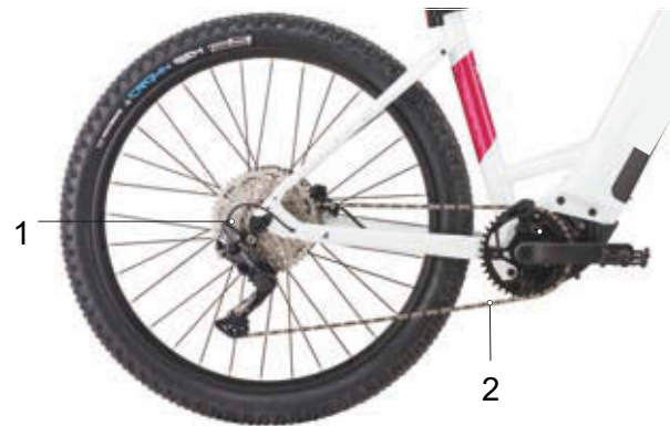
Afbeelding 31: Schema kettingaandrijving met derailleur
