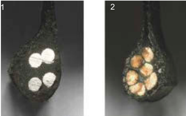
Afbeelding 12: draadkern (1) en Kevlarkern (2)
