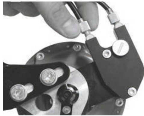
Afbeelding 154: Bij ROHLOFF naafversies met externe schakelaansturing zit de kabelafsteller op de kabelbox aan de linkerkzijde
