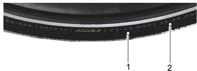
Afbeelding 126: Gegevens vuldruk in bar (1) en psi (2)
