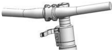
Illustration 128 : Exemple d'un All Up avec levier de serrage de la potence ouvert
