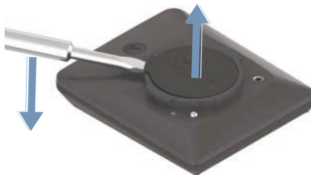
Illustration 108 : Soulever le couvercle du compartiment des piles
