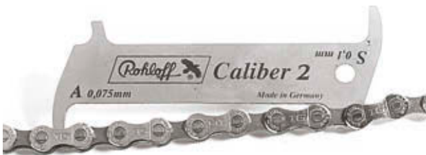
Illustration 168 : Exemple d'un gabarit de mesure ROHLOFF
