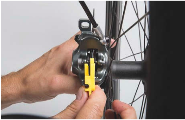
Illustration 163 : Contrôler la plaquette de frein montée à l'aide de la cale de transport
