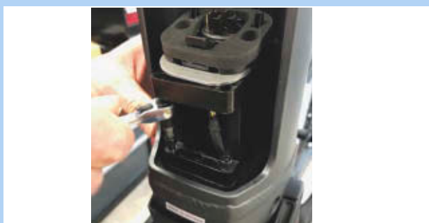
Illustration 53 : Retirer les vis à 6 pans de 4 mm
