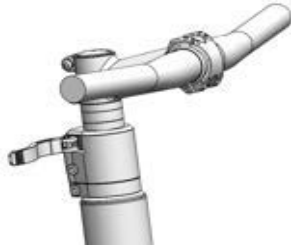
Illustration 154 : Exemple d'un All Up avec levier de serrage de la potence ouvert
