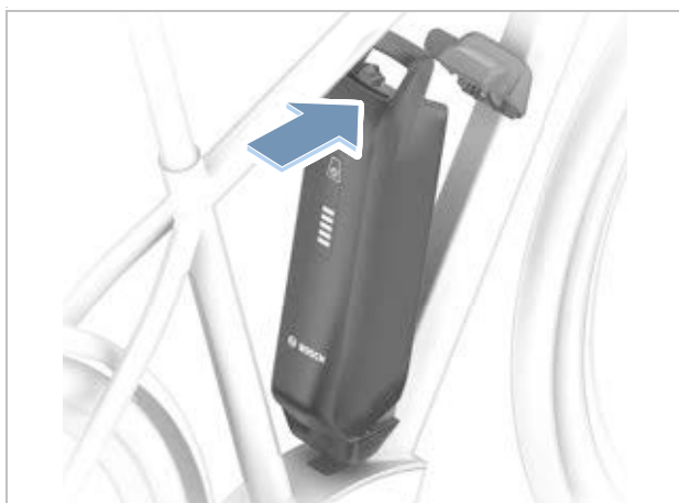
Illustration 136 : Rabattre la batterie PowerPack vers le haut
