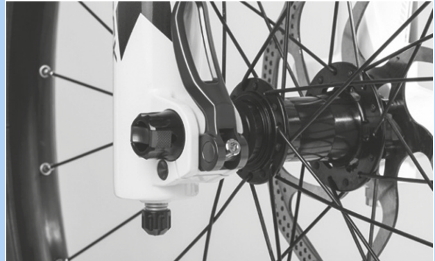
Illustration 191 : Régler la force de serrage de l'attache rapide
