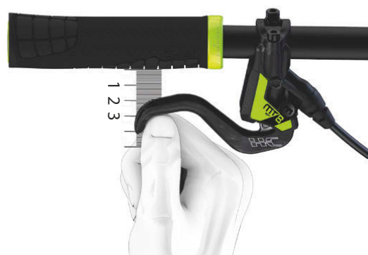
Illustration 100 : Positionnement du frein à main
