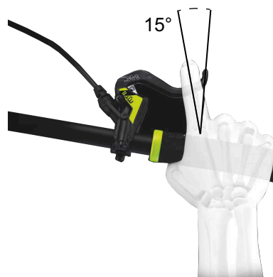
Illustration 97 : Position du frein à main
