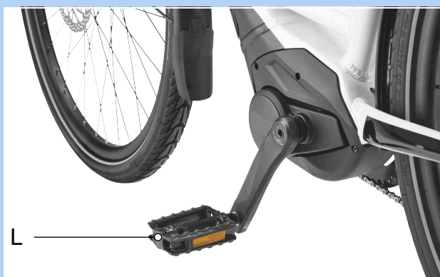
Illustration 69 : Pédale L dans le bras de manivelle gauche
