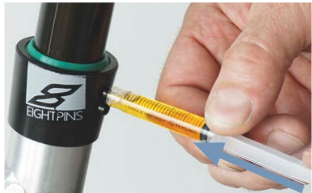
Illustration 159 : Lubrifier une tige de selle eightpins
