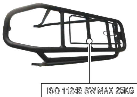
Illustration 131 : La capacité de charge maximale (1) est indiquée sur le porte-bagages.
