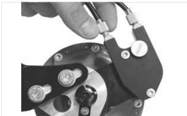
Figur 169: På udgaver af ROHLOFF-nav med ekstern skifteaktivering sidder kabelindstilleren på wireboksen, som sidder på venstre side
