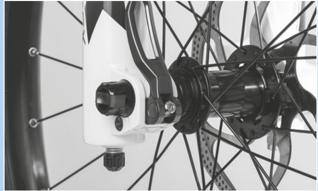
157. ábra: A gyorszár szorítóerejének beállítása
