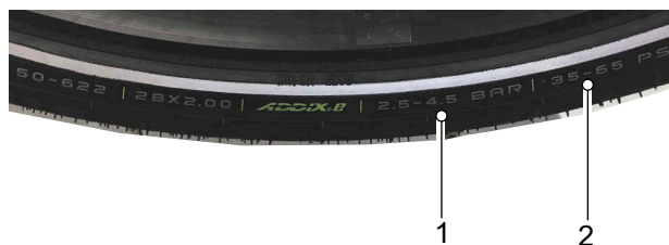
126. ábra: Guminyomás bar-ban (1) és psi-ben (2)
