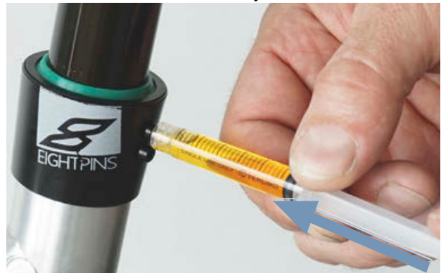
125. ábra: eightpins nyeregcső kenése
