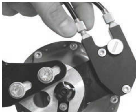
154. ábra: Külső váltóvezérléssel rendelkező ROHLOFF agyváltozatok húzásbeállítója a kötéldobozon van, ami a bal oldalon található
