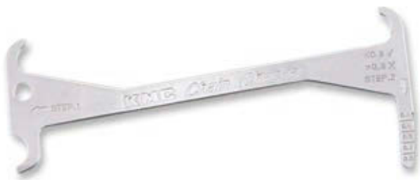
131. ábra: KMC mérőidom példája
