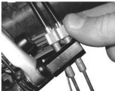
153. ábra: Belső váltóvezérléssel rendelkező ROHLOFF agyváltozatok húzásbeállítója a húzásellentartón van
