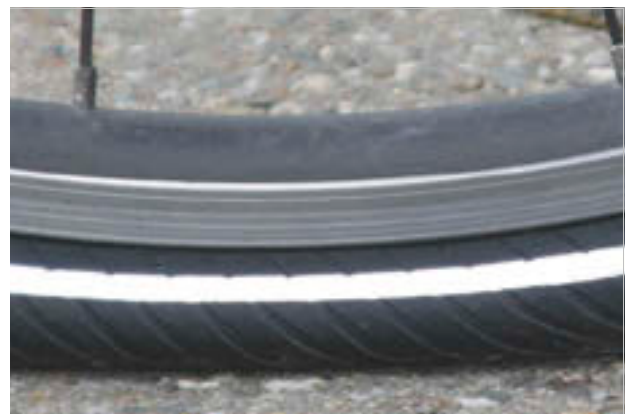
80. ábra: Túlontúl alacsony töltőnyomás
