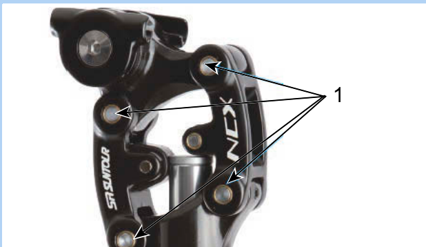
159. ábra: SR SUNTOUR rugós nyeregcső kenőpontjai
