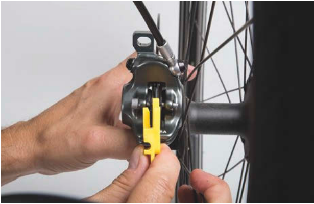
129. ábra: Fékbetét ellenőrzése beépített állapotban a szállítási rögzítés segítségével
