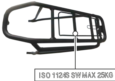
110. ábra: A csomagtartón fel van tüntetve maximális teherbírása (1)
