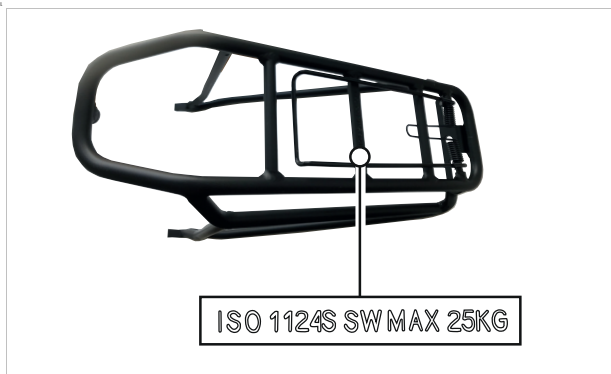
Abbildung 104: Auf dem Gepäckträger ist seine maximale Tragfähigkeit (1) ausgewiesen.
