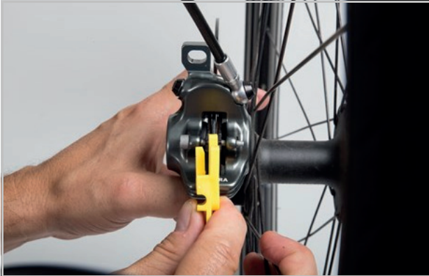
Abbildung 195: Bremsbelag im eingebauten Zustand mithilfe der Transportsicherung prüfen
