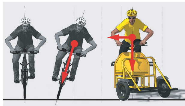
Abbildung 54: Unterschied Fahrrad – Lastenrad
