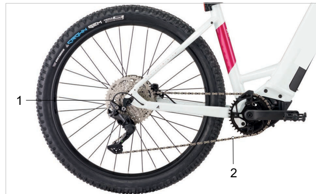
Abbildung 53: Schema Kettenantrieb mit Kettenschaltung
