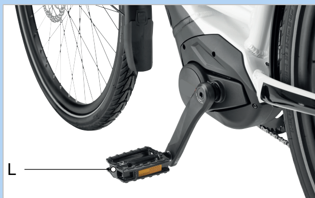
Abbildung 100: L-Pedal im linken Kurbelarm
