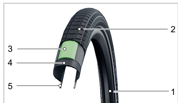
Abbildung 31: Aufbau offener Reifen
