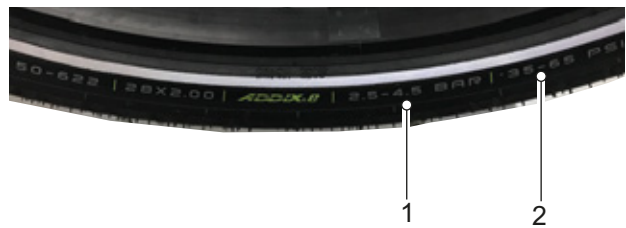
Afbeelding 114: Vuldruk in bar (1) en psi (2)
