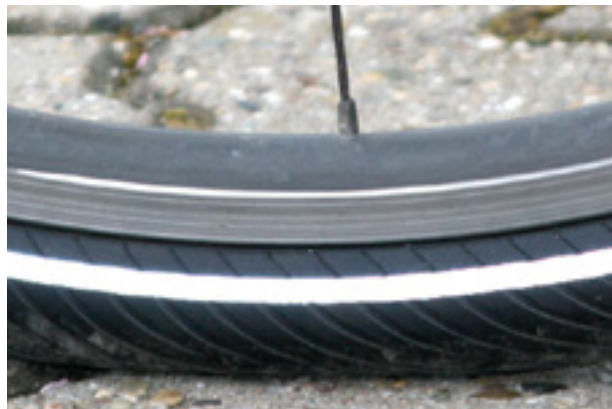
Afbeelding 67: Juiste vuldruk. De band is onder de belasting van het lichaamsgewicht nauwelijks vervormd
