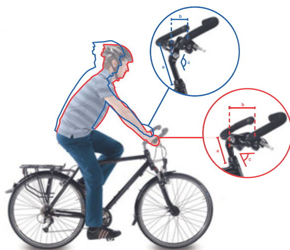
Afbeelding 65: Stadsfiets- (blauw) en toerfietsstand (rood) door verandering van de hoek
