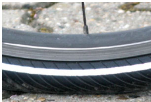
Afbeelding 57: Juiste vuldruk. De band is onder de belasting van het lichaamsgewicht nauwelijks vervormd
