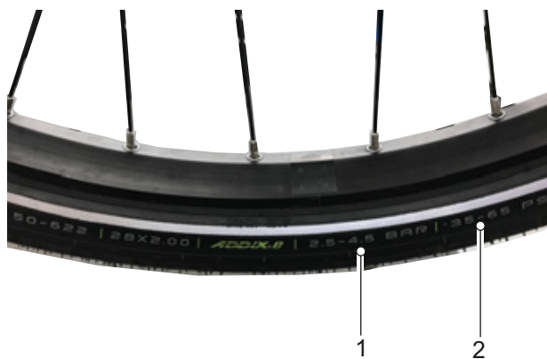
97. ábra: Guminyomás bar-ban (1) és psi-ben (2)
