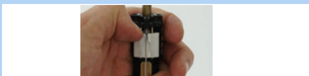
137. ábra: Fehér működtető kapcsoló lefelé tolása
