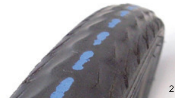
98. ábra: Profil nélküli gumiabroncs, amivel még kerékpározni lehet (1), és cserélendő gumiabroncs áttetsző defektvédelemmel (2)
