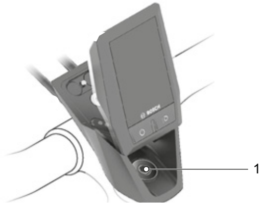
72. ábra: A vezérlőegység-csavar elhelyezkedése
