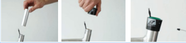
168. ábra: Siklópersely és külső hüvely beépítése
