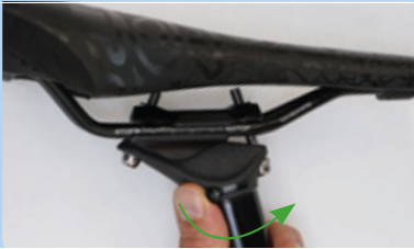
162. ábra: Magasságállítás nyitása
