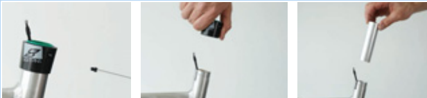
119. ábra: Külső hüvely és siklópersely kiszérése
