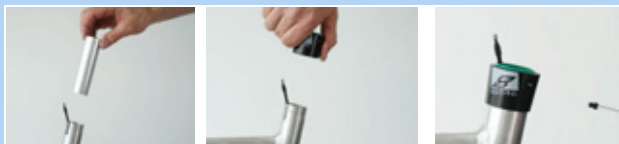
135. ábra: Siklópersely és külső hüvely beépítése
