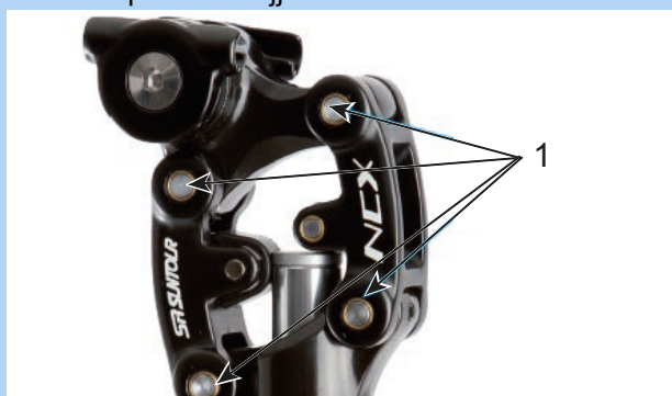
110. ábra: SR kenőpontok Suntour rugós nyeregcső
