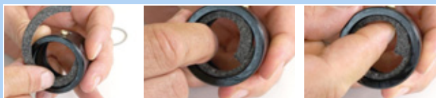
124. ábra: Filcgyűrű behelyezése
