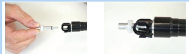
128. ábra: Szelepadapter becsavarozása
