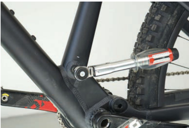
44. ábra: A nyeregcsőtengely meghúzása
