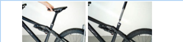
151. ábra: A nyeregcső eltávolítása
