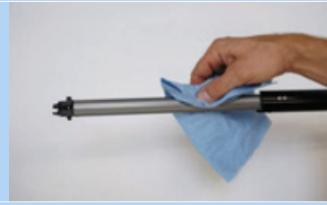
164. ábra: Hosszirányú vezetőhorny tisztítása
