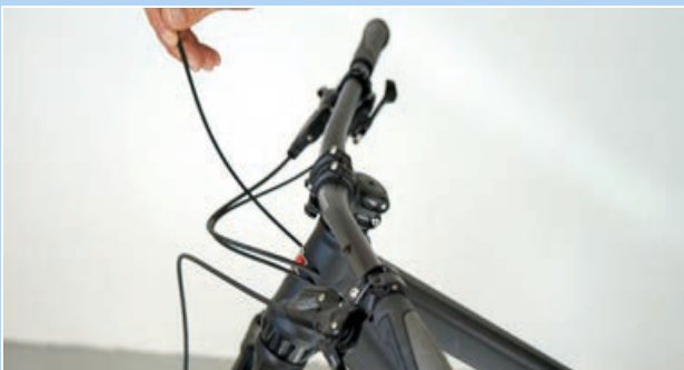
170. ábra: Végsapka beakasztása
