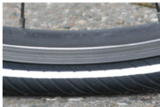
61. ábra: Túlontúl alacsony töltőnyomás
