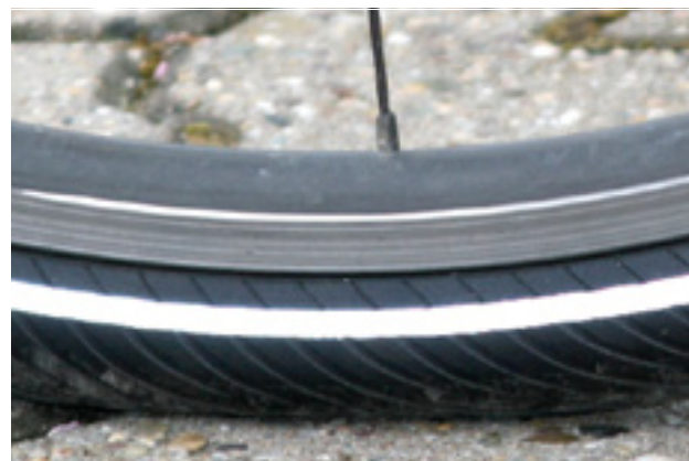
60. ábra: Helyes töltőnyomás. A gumiabroncs alakja a testsúly terhe alatt alig változik
