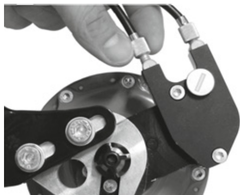
104. ábra: Külső váltóvezérléssel rendelkező Rohloff agyváltozatok húzásbeállítója a kötéldobozon van, ami a bal oldalon található
