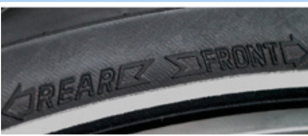
38. ábra: Futásirányjelző nyíl MTB gumiabroncsokon
