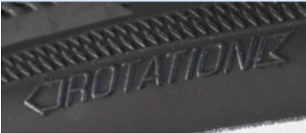
37. ábra: Futásirányjelző nyíl
