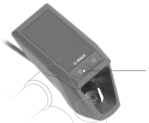
Afbeelding 85: Locatie aan/uit-toets (bediening)
