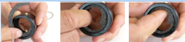
Afbeelding 159: Vilten ring inleggen
