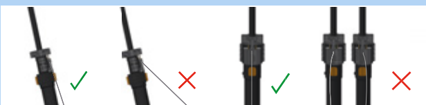
Afbeelding 138: Correcte en verkeerde bowdenkabel
