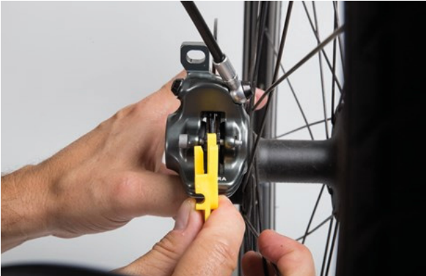
Afbeelding 100: Remvoering in gemonteerde toestand controleren met behulp van de transportbeveiliging
