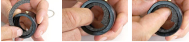
Afbeelding 124: Vilten ring inleggen
