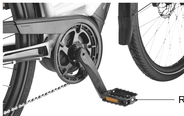
Figur 66: R Pedal i højre pedalarm
