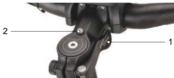
Figur 63: Frempind, udførelse II med greb på frempindens hurtigbespænding (1) og frigørelsesknap (2)
