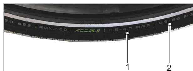
Figur 154: Oplysninger om dæktryk i bar (1) og psi (2)
