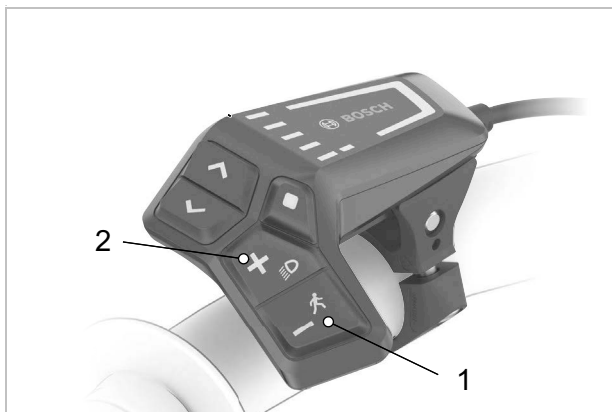
Figur 139: Plus-tastens og Minus-tastens position
