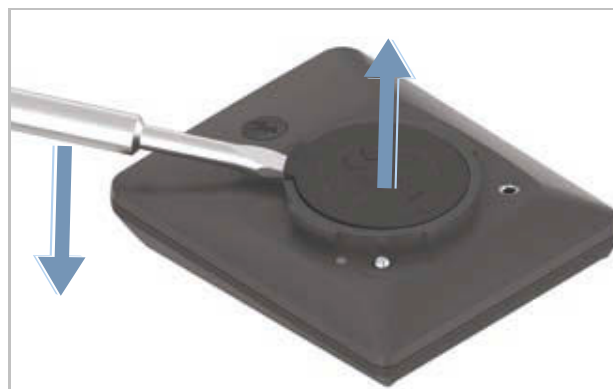
Figur 104: Løftning af batterirummets kappe
