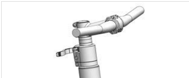
Figur 147: Eksempel All Up med løsnet frempindsgreb
