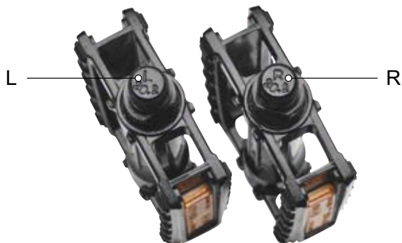
Figur 64: Eksempel på mærkning af pedaler
