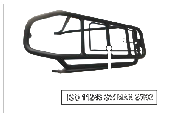
Figur 130: Bagagebærerens maksimale bæreevne (1) er angivet på bagagebæreren
