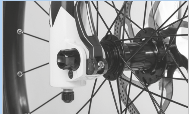
Figur 185: Indstilling af hurtigbespændingens spændekraft
