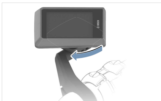
Figur 107: Drejning af displayet med uret
