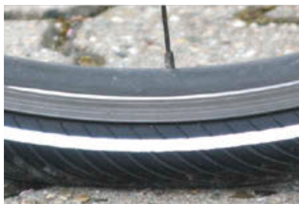
Afbeelding 90: Juiste vuldruk. De band is onder de belasting van het lichaamsgewicht nauwelijks vervormd
