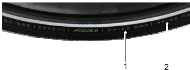
114. ábra: Guminyomás bar-ban (1) és psi-ben (2)
