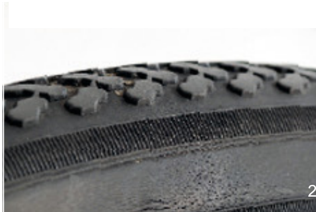
116. ábra: Példák kifáradási repedésekre (1) és öregedési repedésekre (2)
