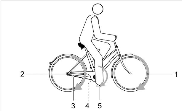
Illustration 32 : Schéma du système d'entraînement mécanique
