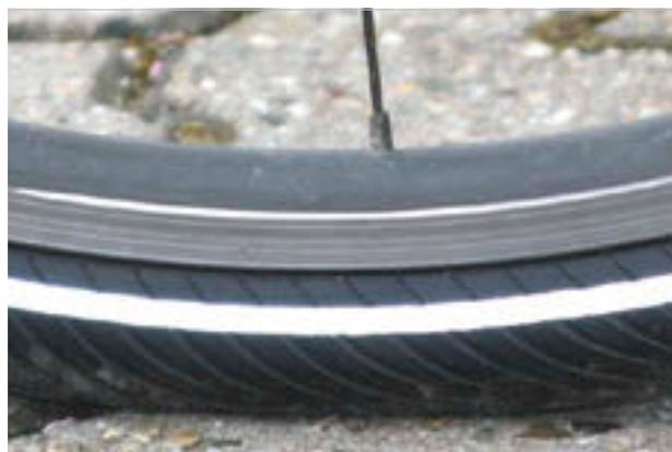
Illustration 90 : Pression correcte. Le pneu se déforme à peine sous le poids du corps.
