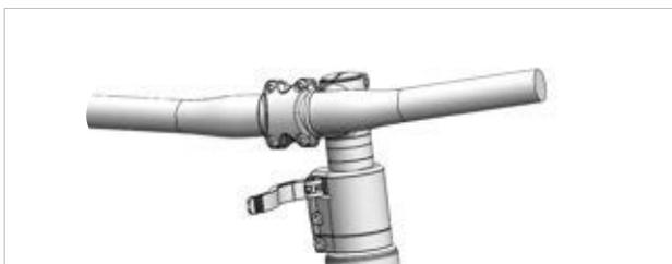
Illustration 126 : Exemple d'un All Up avec levier de serrage de la potence ouvert
