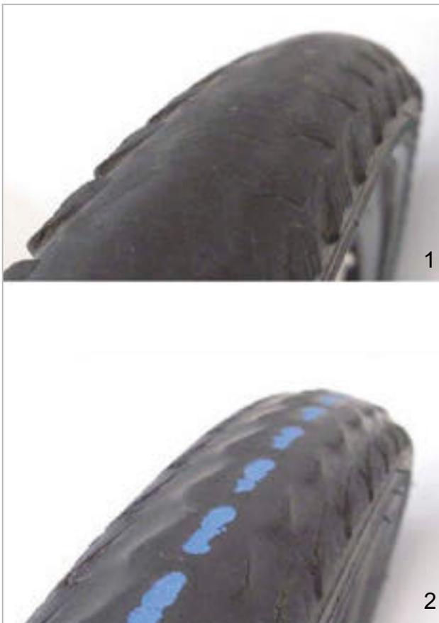
Illustration 155 : Pneu sans profil pouvant être changé (1) et pneu avec protection anti-crevaison visible (2) devant être changé
