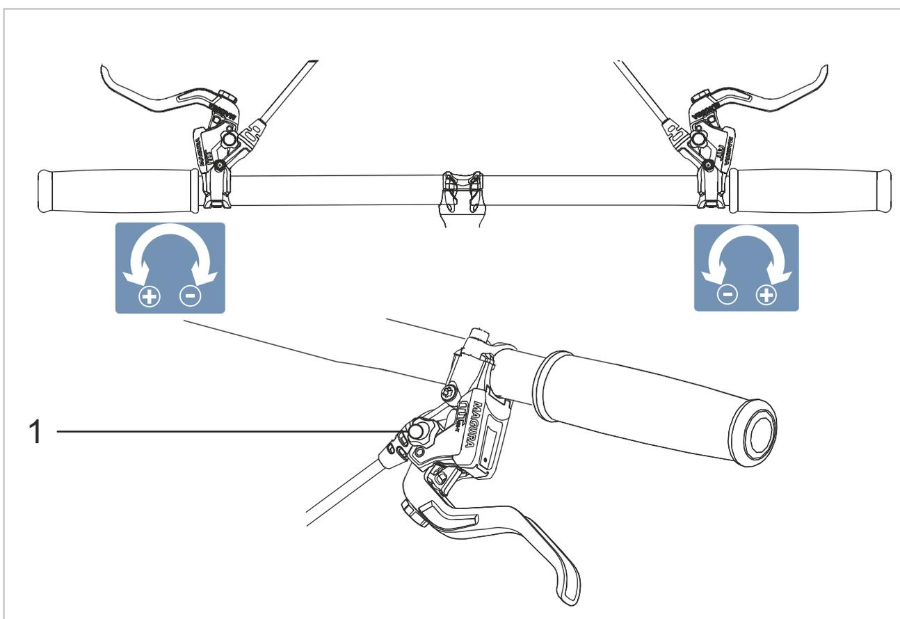
Illustration 97 : Utilisation du bouton rotatif (1) pour le réglage du point de pression
