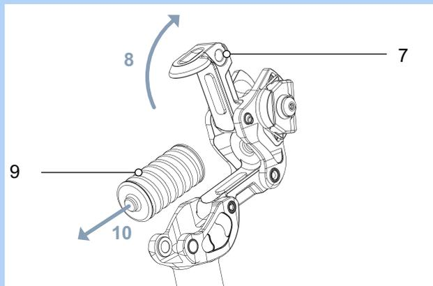
Illustration 56 : Incliner le bras de suspension (7) vers l'arrière (4) et retirer (10) l'élément de suspension (9)
