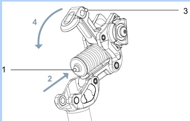
Illustration 57 : Placer (2) l'élément de suspension (1) et faire pivoter le bras de suspension arrière (3) vers le bas (4)
