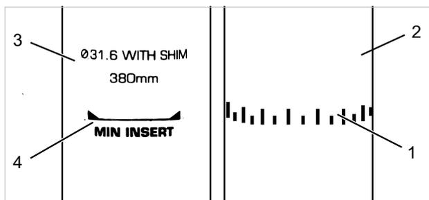
Illustration 78 : Vue détaillée de la tige de selle, exemples de marquage de la profondeur d'insertion minimale
