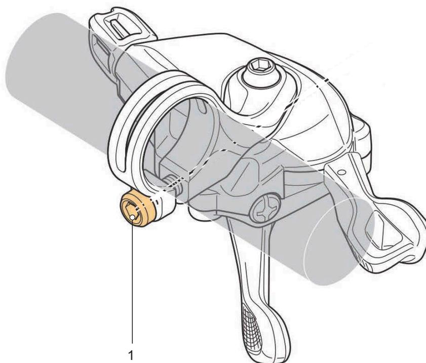
Illustration 99 : Position de la vis de fixation (1)
