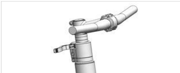
Illustration 147 : Exemple d'un All Up avec levier de serrage de la potence ouvert
