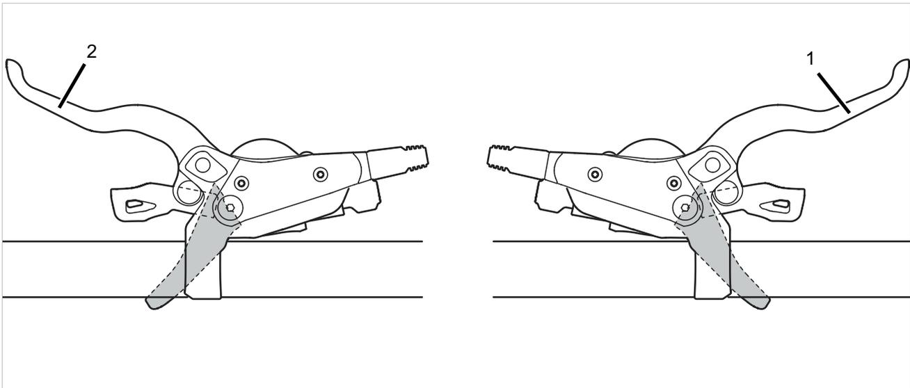
Illustration 47 : Freins à main arrière (1) et avant (2), exemple d'un frein SHIMANO
