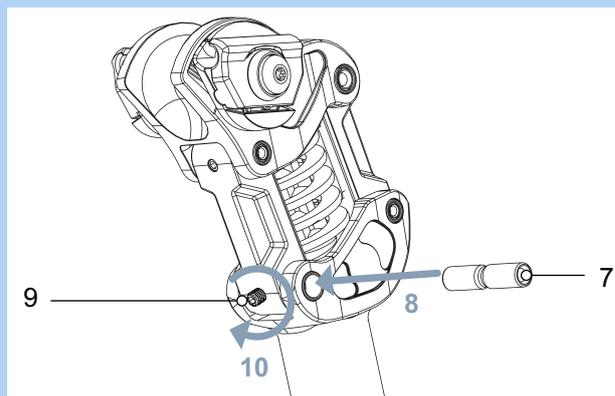
Illustration 59 : Graisser l'axe en acier inoxydable (7) et serrer la vis sans tête de fixation (10)
