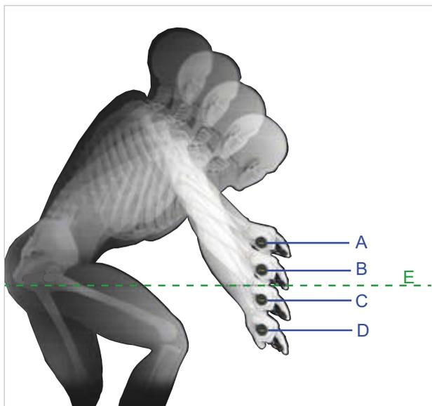
Illustration 93 : Exemple de 4 hauteurs de guidon différentes (A, B, C et D) avec une hauteur de selle (E)
