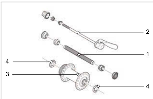
Illustration 19 : Exemple d'un moyeu de roue avant, SHIMANO
