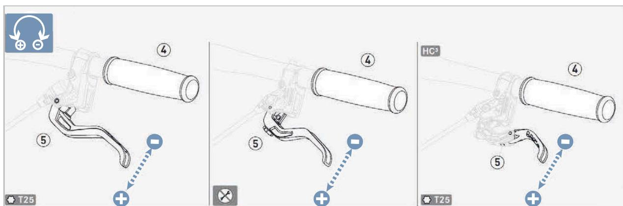
Illustration 96 : Régler la garde d'un levier de frein à disque MAGURA
