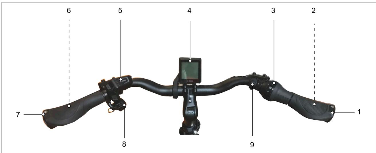
Illustration 42 : Vue détaillée d'un guidon avec BOSCH Intuvia 100, exemple
