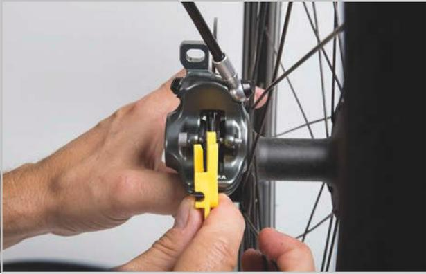
Illustration 157 : Contrôler la plaquette de frein montée à l'aide de la cale de transport
