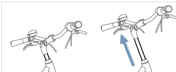
Illustration 85 : Régler la hauteur de la potence à plongeur
