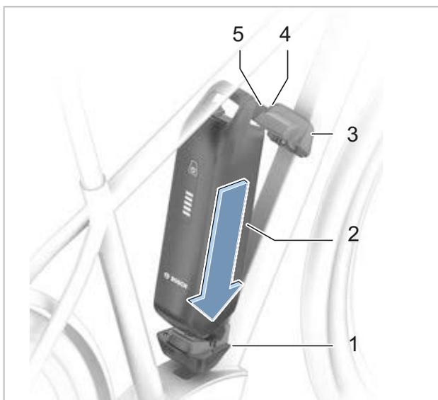
Illustration 124 : Insérer la batterie PowerPack
