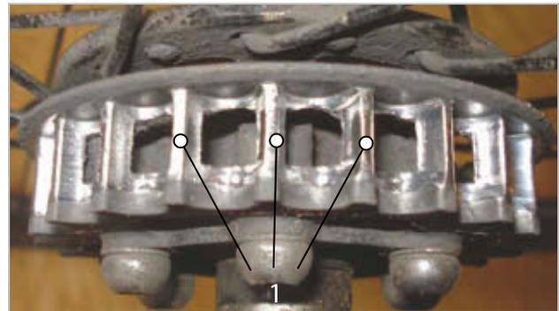
Illustration 171 : Exemple de photo d'un profil de cran usé
