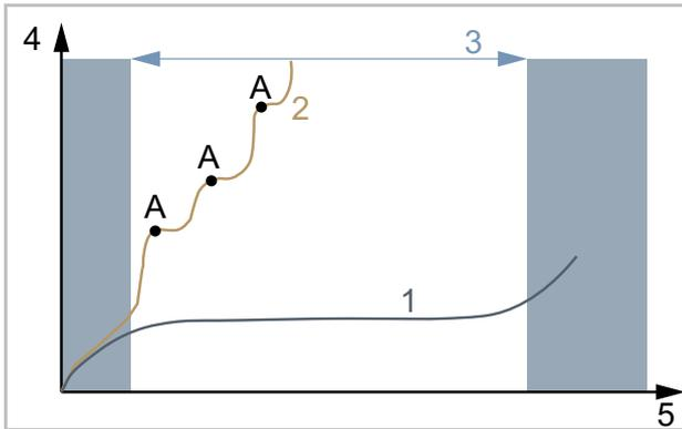
Illustration 151 : Diagramme d'usure, durée de service (5) par rapport à l'enlèvement de matière (4)
