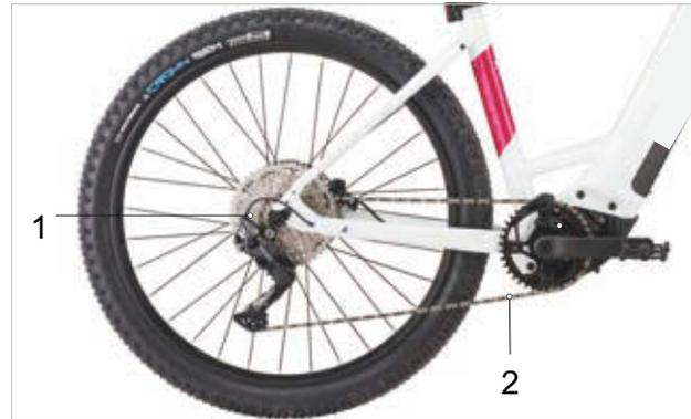
Illustration 33 : Schéma de l'entraînement à chaîne avec dérailleur
