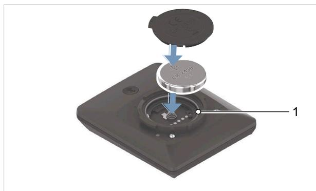
Illustration 105 : Insérer la pile en veillant à la position du joint (1)
