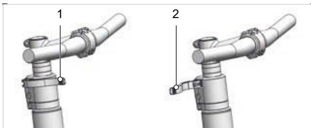
Illustration 83 : Levier de serrage de la potence fermé (1) et ouvert (2), exemple d'un All Up
