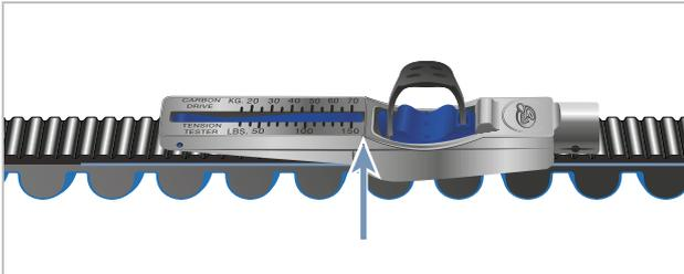
Illustration 173 : Gabarit de contrôle sur la courroie
