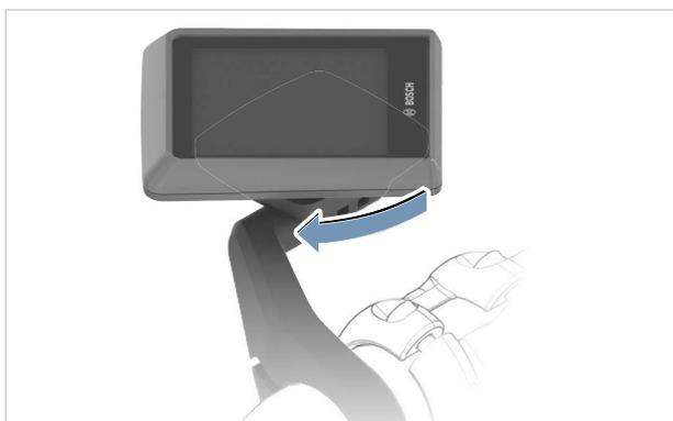
Illustration 107 : Tourner l'écran dans le sens des aiguilles d'une montre
