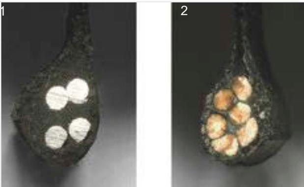
Illustration 14 : tringle en acier (1) et tringle en Kevlar (2)
