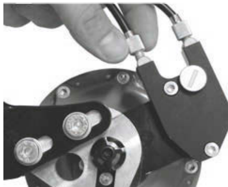
188. ábra: Külső váltóvezérléssel rendelkező ROHLOFF agyváltózatok húzásbeállítója a kötéldobozon van, ami a bal oldalon található
