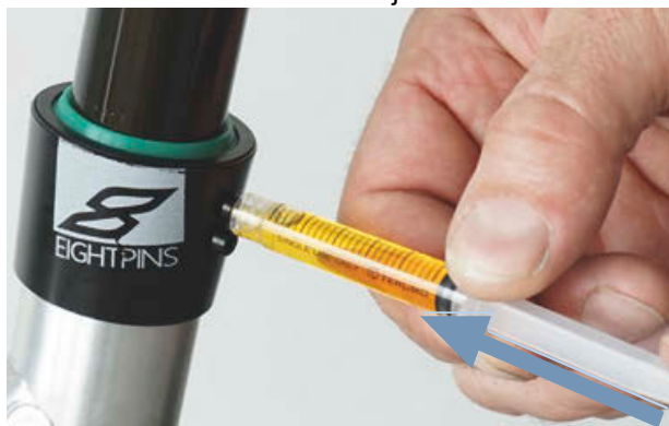
159. ábra: eightpins nyeregcső kenése
