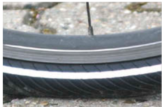
95. ábra: Helyes töltőnyomás. A gumiabroncs alakja a testsúly terhe alatt alig változik
