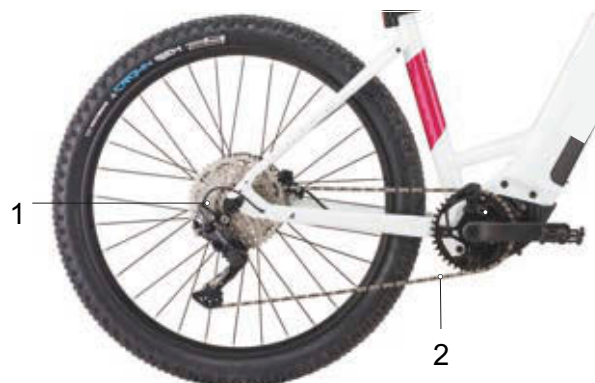
32. ábra: Külső váltóval felszerelt lánchajtás vázlata
