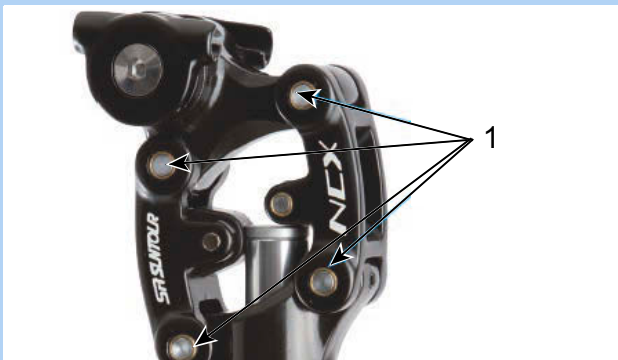
193. ábra: SR SUNTOUR rugós nyeregcső kenőpontjai
