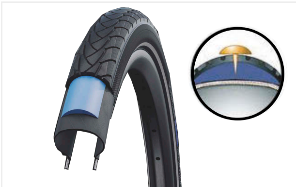
Figur 28: Effekten af et punkteringsbeskyttelsesbælte
