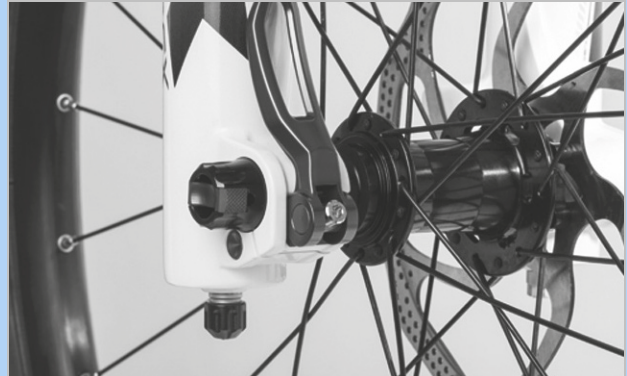
Figur 213: Indstilling af hurtigbespændingens spændekraft
