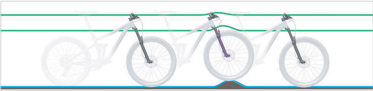
Figur 17: Fjedergaflens optimale køremåde ved ujævnheder
