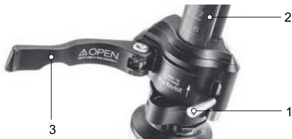
Figur 91: Åbnet greb på hurtigbespændingen (3) på frempinden (2), udførelse I, med låsegreb på frempinden (1)
