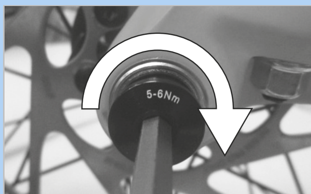
Figur 80: Spænding af sikringsskrue
