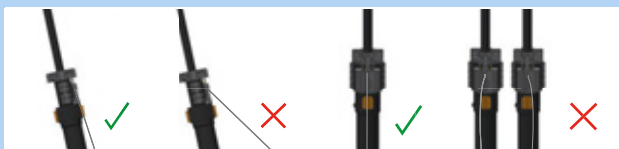
Figura 142: Cable Bowden correcto e incorrecto
