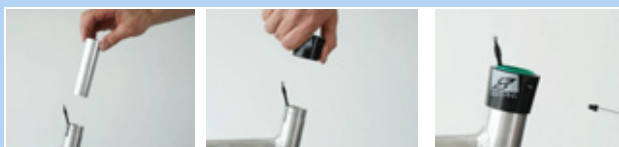
Figura 139: Montaje del casquillo deslizante y del manguito exterior
