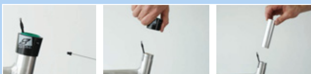
Figura 123: Desmontaje del manguito exterior y del casquillo deslizante
