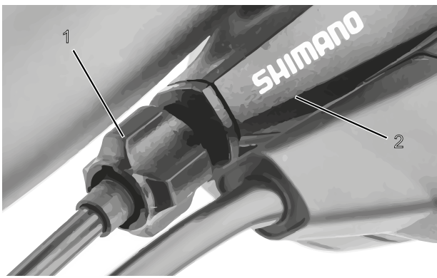
Figura 109: Casquillo de ajuste (1) del cambio de marchas accionado por cable de accionamiento con carcasa de la palanca de cambio (2), ejemplo
