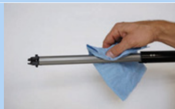
Figura 168: Limpieza de la ranura de guía longitudinal
