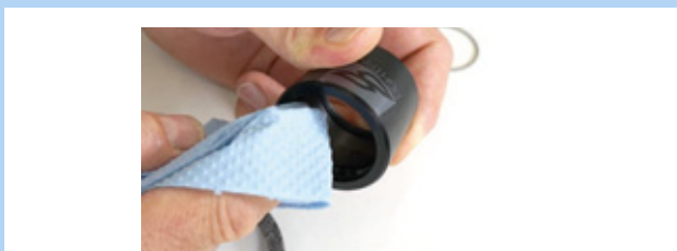
Figura 162: Limpieza del manguito exterior
