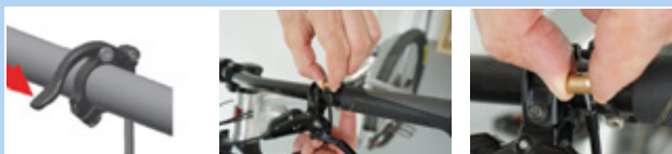
Figura 117: Desmontaje del cartucho
