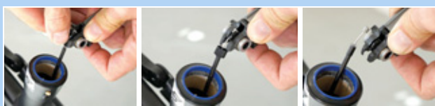
Figura 156: Retirada del cable Bowden
