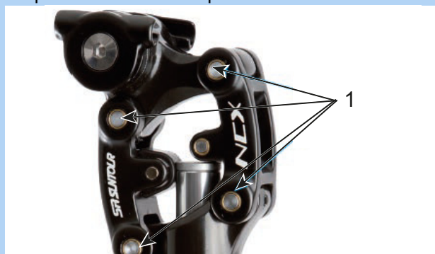
Figura 114: Puntos de lubricación de la tija de sillín de muelle SR Suntour
