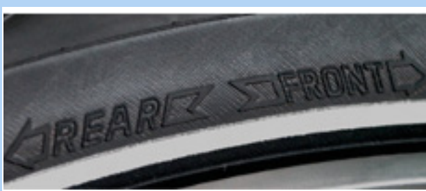
Figura 43: Flecha de sentido de la marcha en cubiertas de MTB
