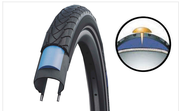
Figura 15: Efectividad del cinturón de protección contra pinchazos
