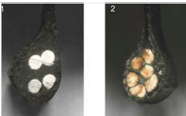
Figura 14: Núcleo de acero (1) y núcleo de Kevlar (2)
