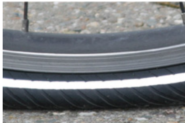
Figura 68: Presión de inflado demasiado baja
