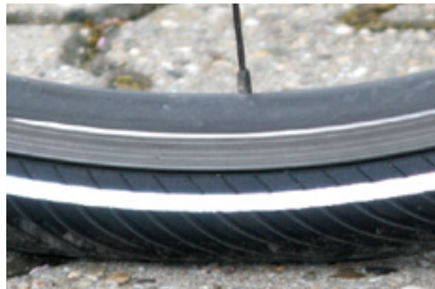
Figura 67: Presión de inflado correcta. La cubierta apenas está deformada bajo la carga del peso corporal
