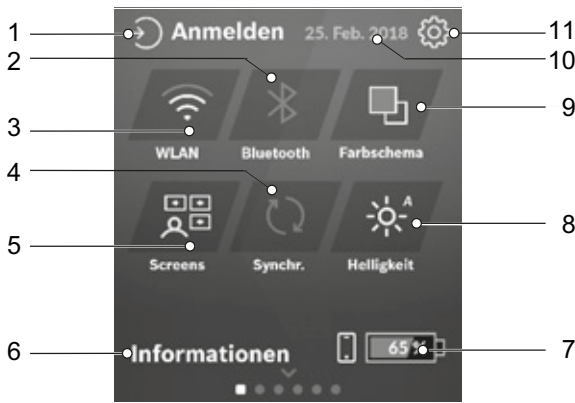
Figura 30: Vista general de la <PANTALLA DE ESTADO>
