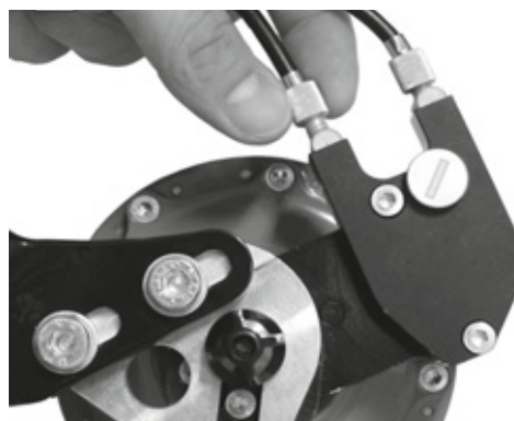
Figura 121: Las versiones de bujes ROHLOFF con activación de cambio externa tienen los dispositivos de ajuste de tensión en la caja de cables que se encuentra en el lado izquierdo
