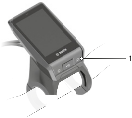
Figura 100: Posición del botón de la luz de marcha
