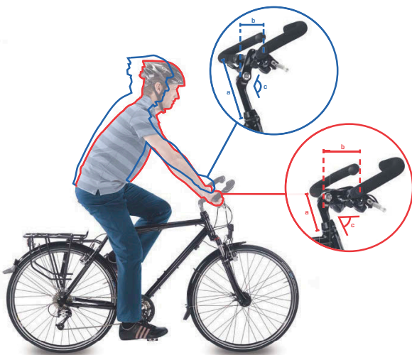
Illustration 77 : Position sur vélo de ville (en bleu) et sur vélo tout chemin (en rouge) avec modification de l'angle
