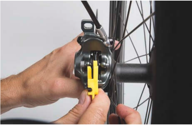
Illustration 129 : Contrôler la plaquette de frein montée à l'aide de la cale de transport
