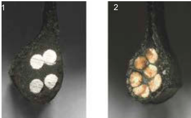
Illustration 12 : tringle en acier (1) et tringle en Kevlar (2)
