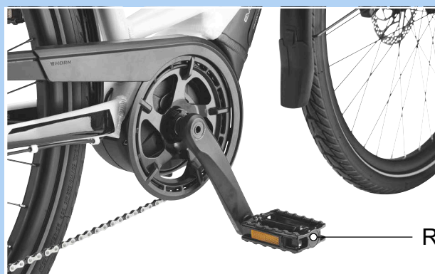
Illustration 54 : Pédale R dans le bras de manivelle droit
