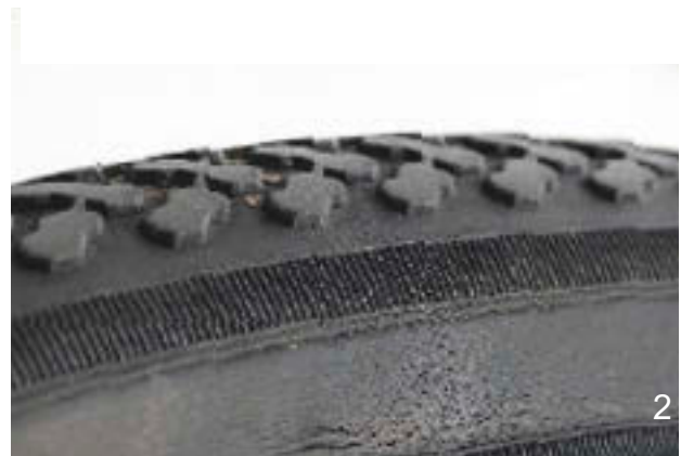
Illustration 128 : Exemples de fissures de fatigue (1) et de fissures d'âge (2)
