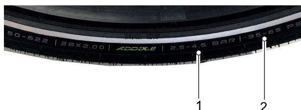
Abbildung 103: Fülldruck in bar (1) und psi (2)
