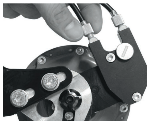
Abbildung 110: ROHLOFF-Naben Versionen mit externer Schaltansteuerung haben die Zugeinsteller an der Seilbox, die sich auf der linken Seite befindet
