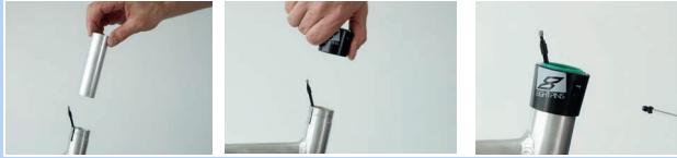
Abbildung 173: Gleitbuchse und Außenhülse einbauen
