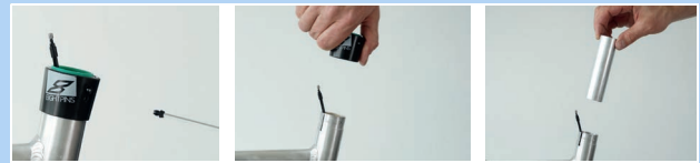
Abbildung 158: Außenhülle und Gleitbuchse ausbauen
