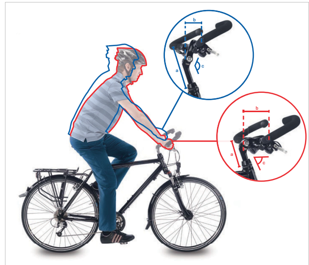
Abbildung 81: Citybike (blau) und Trekkingrad Position (rot) durch Winkeländerung
