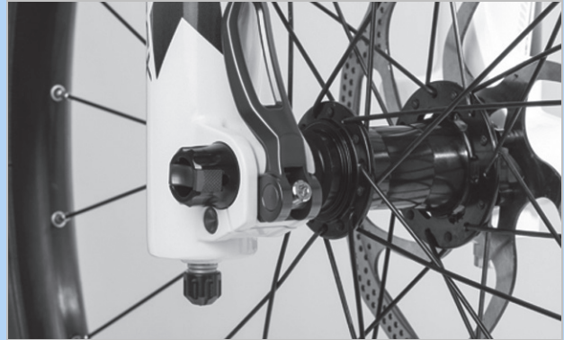
Abbildung 180: Spannkraft des Schnellspanners einstellen
