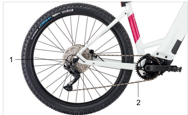
Abbildung 32: Schema Kettenantrieb mit Kettenschaltung
