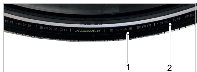
Abbildung 149: Angabe Fülldruck in bar (1) und psi (2)
