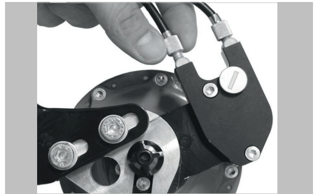
Abbildung 177: ROHLOFF-Naben Versionen mit externer Schaltansteuerung haben die Zugeinsteller an der Seilbox, die sich auf der linken Seite befindet
