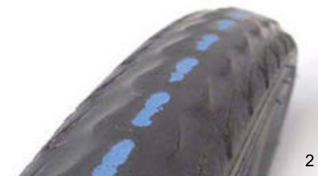
Figur 141: Dæk uden profil, som kan udskiftes (1), og dæk, hvor punkteringsbeskyttelsen (2) kan ses gennem slidbanen, og som skal udskiftes
