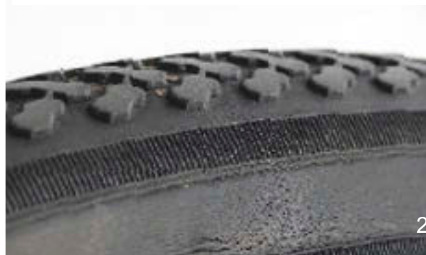
Figur 142: Eksempler på svækkelsesrevner (1) og ældningsrevner (2)
