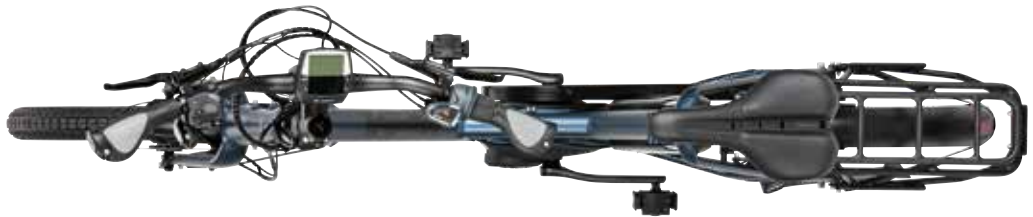
i:SY hier mit um 90° gedrehtem Lenker (SPEED LIFTER Twist „T22“ serienmäßig) und mit eingeklappten Pedalen (Faltpedale serienmäßig)
