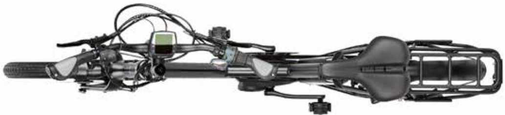
i:SY hier mit um 90° gedrehtem Lenker (SPEED LIFTER Twist „T22“ serienmäßig) und mit eingeklappten Pedalen (Faltpedale serienmäßig)
