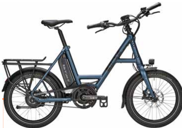
i:SY hier mit um 90° gedrehtem Lenker (einfache, werkzeugfreie Handhabung SPEED LIFTER Twist „T22“- serienmäßig)
