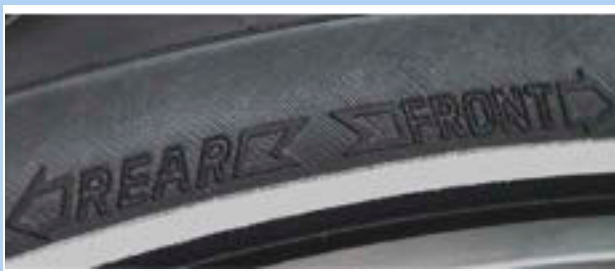
Afbeelding 67: Pijl draairichting op MTB-banden
