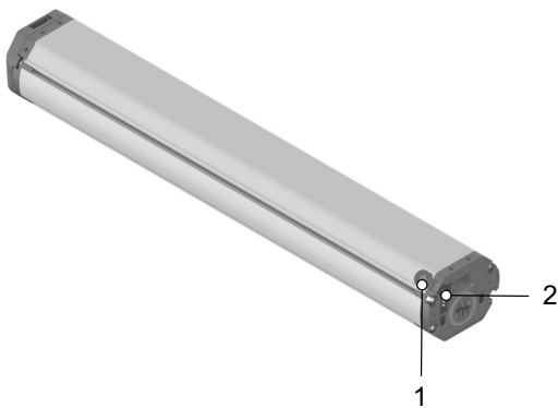
Afbeelding 46: Weergave en bedieningselement BOSCH Power Tube
