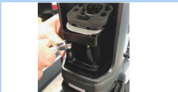
Afbeelding 53: 4 mm zeskantschroeven verwijderen
