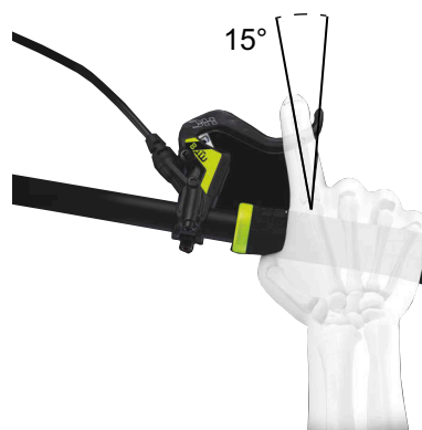
Afbeelding 97: Stand van de handrem
