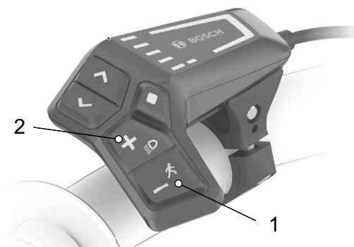
Afbeelding 142: Locatie plus-toets en min-toets
