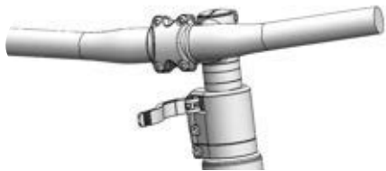
Afbeelding 128: Voorbeeld All Up met geopende voorbouwspanhendel
