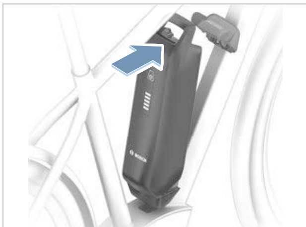
Afbeelding 136: PowerPack accu omhoog klappen
