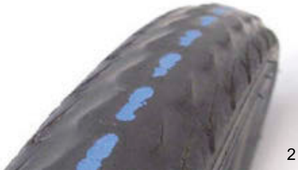
Afbeelding 161: Een band zonder profiel, die kan worden vervangen (1) en een band met zichtbare lekbescherming (2), die moet worden vervangen
