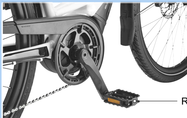
Afbeelding 70: R-pedaal in de rechter crankarm
