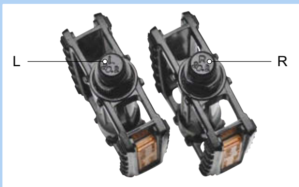
Afbeelding 68: Voorbeeld markering op pedalen
