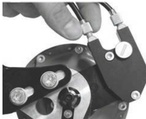
Figur 188: På udgaver af ROHLOFF-nav med ekstern skifteaktivering sidder kabelindstilleren på wireboksen, som sidder på venstre side
