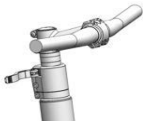
Figur 154: Eksempel All Up med løsnet frempindsgreb
