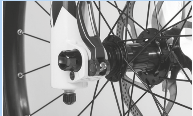
Figur 191: Indstilling af hurtigbespændingens spændekraft
