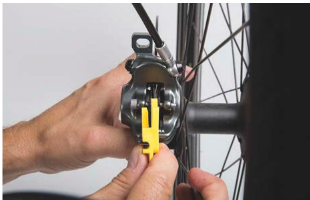
Figur 163: Kontrol af bremsebelægning i indbygget tilstand vha. transportsikringen
