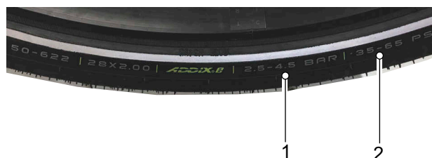
Figur 160: Oplysninger om dæktryk i bar (1) og psi (2)
