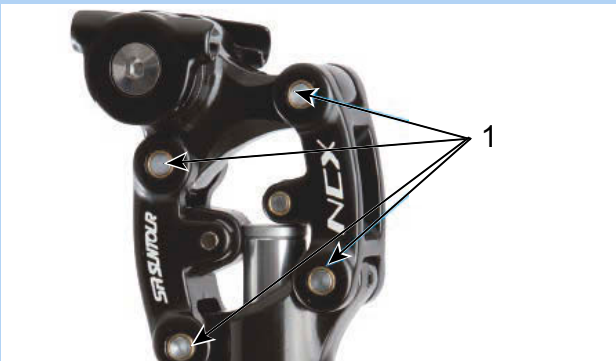
Figur 193: Smørepunkter på SR SUNTOUR affjedret sadelpind
