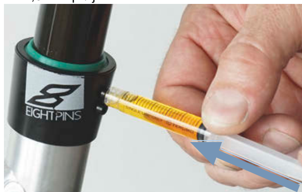
Figur 159: Smøring af eightpins-sadelpind
