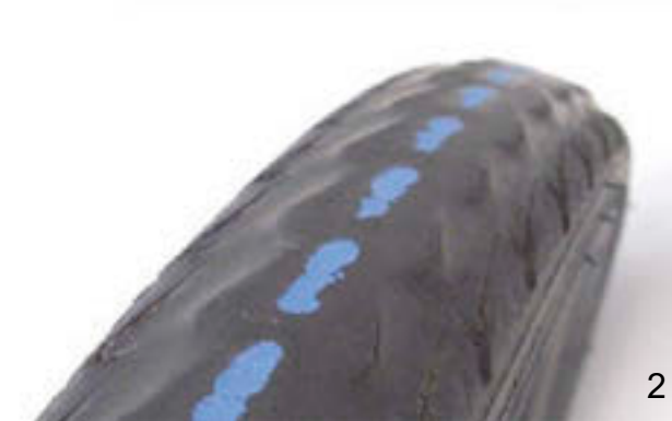
Figur 161: Dæk uden profil, som kan udskiftes (1), og dæk, hvor punkteringsbeskyttelsen (2) kan ses gennem slidbanen, og som skal udskiftes
