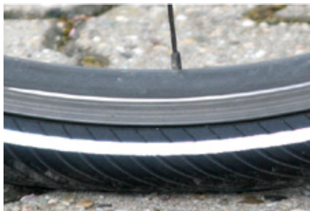
Afbeelding 71: Juiste vuldruk. De band is onder de belasting van het lichaamsgewicht nauwelijks vervormd
