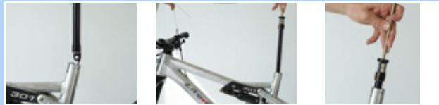
Afbeelding 143: Ventioldop van de patroon aanbrengen
