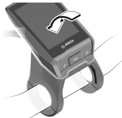
Illustration 78 : Pousser l'ordinateur de bord vers l'avant
