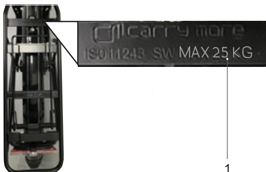
Illustration 96 : La capacité de charge maximale (1) est indiquée sur le porte-bagages.
