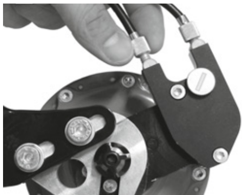
91. ábra: Külső váltóvezérléssel rendelkező ROHLOFF agyváltozatok húzásbeállítója a kötéldobozon van, ami a bal oldalon található
