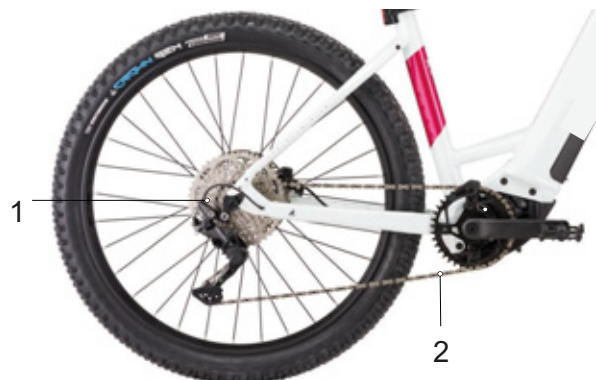
18. ábra: Külső váltóval felszerelt lánchajtás vázlata
