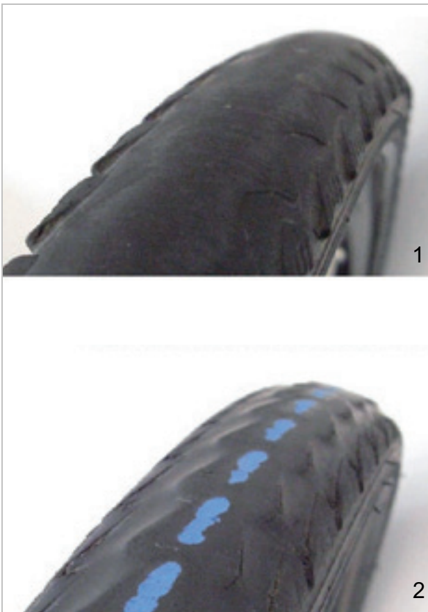
Afbeelding 123: Een band zonder profiel, die kan worden vervangen (1) en een band met zichtbare lekbescherming (2), die moet worden vervangen
