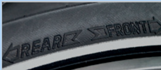
Afbeelding 50: Pijl draairichting op MTB-band
