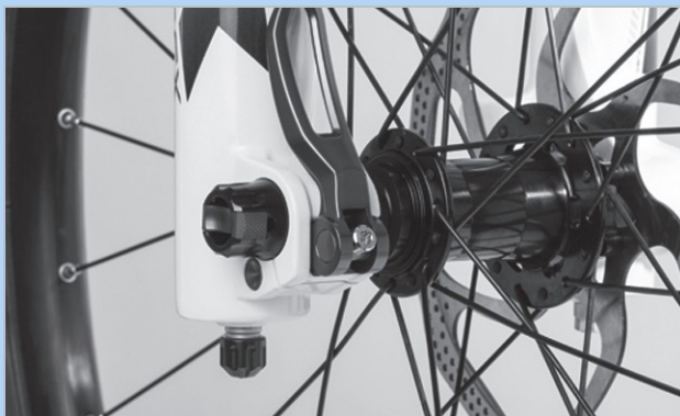
Afbeelding 143: Spankracht van de snelspanner afstellen
