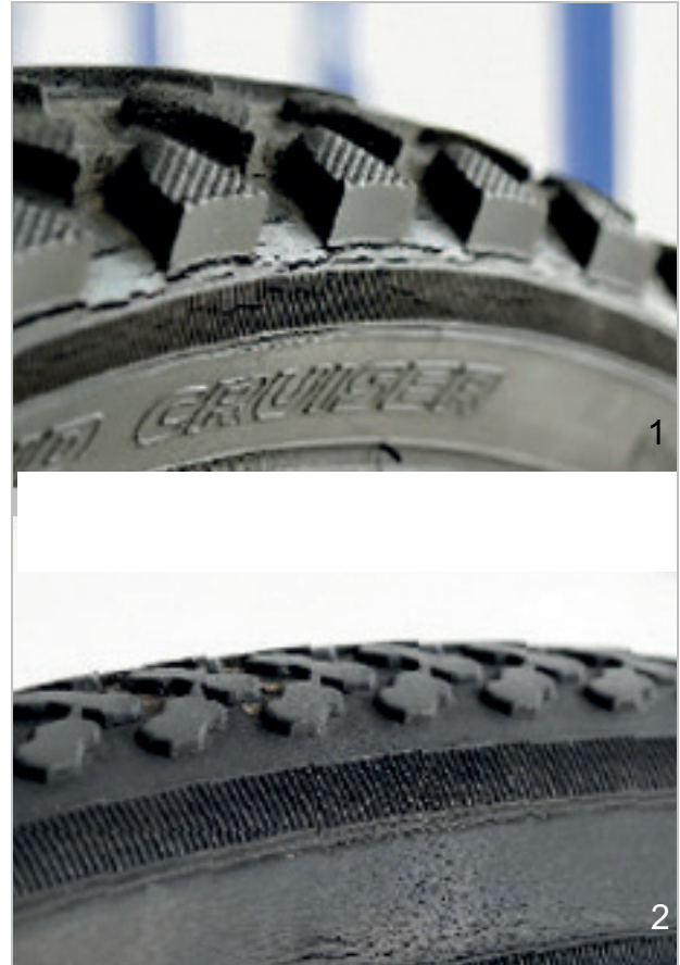
Afbeelding 124: Voorbeelden van vermoeiingsscheuren (1) en verouderingsscheuren (2)
