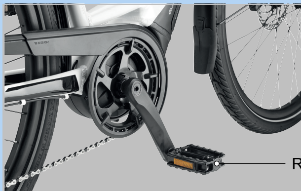
Afbeelding 53: R-pedaal in de rechter crankarm
