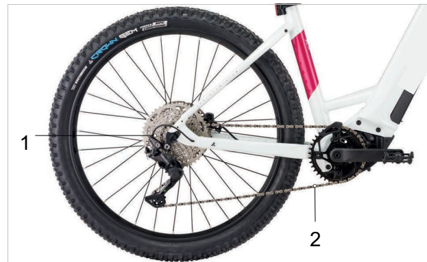
Afbeelding 30: Schema kettingaandrijving met derailleur
