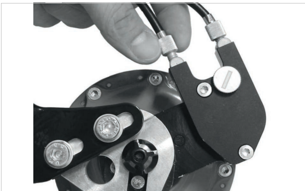
Afbeelding 140: Bij ROHLOFF naafversies met externe schakelaansturing zit de kabelafsteller op de kabelbox aan de linkerkant
