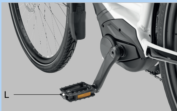
Afbeelding 52: L-pedaal in de linker crankarm
