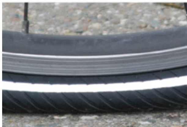
Figura 58: Presión de inflado demasiado baja
