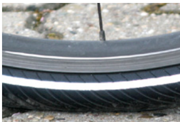
Figura 57: Presión de inflado correcta. La cubierta apenas está deformada bajo la carga del peso corporal
