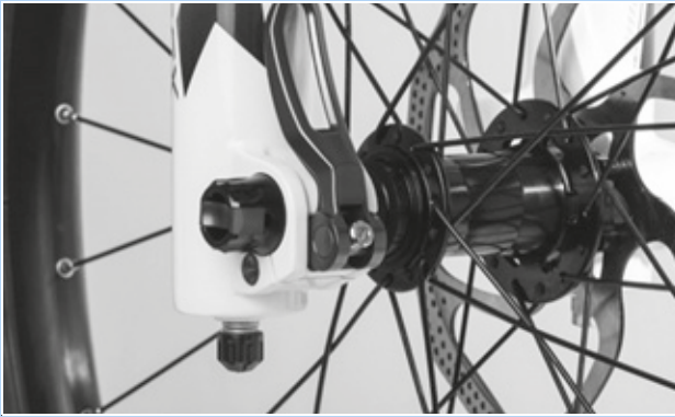
Figura 95: Ajuste de la fuerza de tensado del cierre rápido
