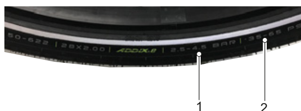
Figura 84: Presión de inflado en bar (1) y psi (2)
