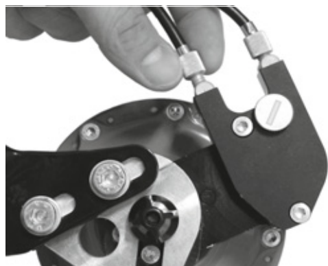
Illustration 110 : Sur les versions de moyeux ROHLOFF avec commande externe du changement de vitesse, le dispositif de réglage de la tension est situé sur le boîtier de câbles qui est placé sur le côté gauche.
