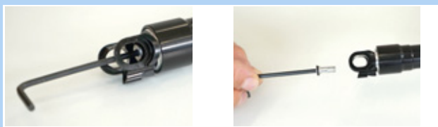
Illustration 137 : Retirer le capuchon de valve
