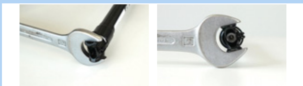
Illustration 138 : Empêcher l'interface de montage de tourner
