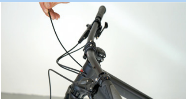
Illustration 176 : Accrocher le capuchon d'extrémité
