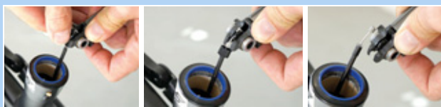
Illustration 158 : Retirer le câble Bowden
