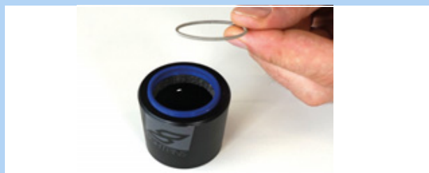
Illustration 161 : Rondelle élastique retirée
