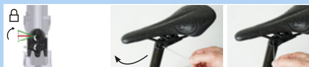
Illustration 154 : Fermer le réglage de la hauteur
