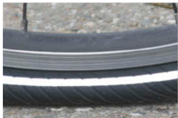
120. ábra: Túlontúl alacsony töltőnyomás
