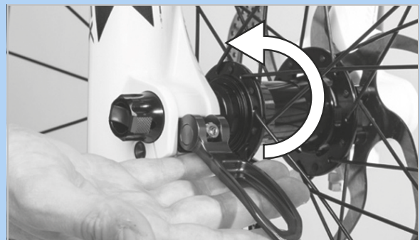
84. ábra: A gyorszár nyomása nyírányban
