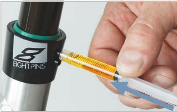
181. ábra: EIGHTPINS nyeregcső kenése
