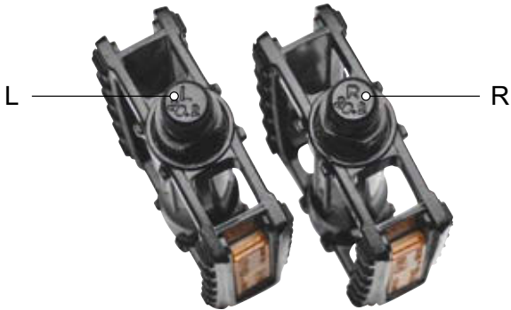
93. ábra: Példa: pedálok jelölése
