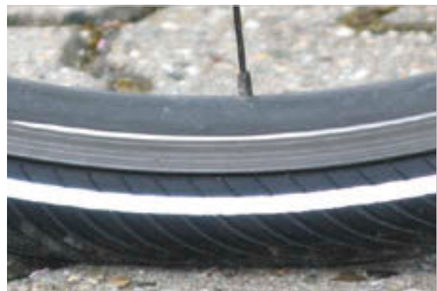
119. ábra: Helyes töltőnyomás. A gumiabroncs alakja a testsúly terhe alatt alig változik
