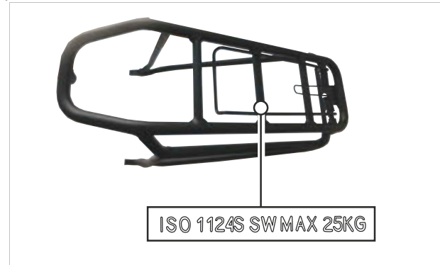
160. ábra: A csomagtartón fel van tüntetve maximális teherbírása (1)
