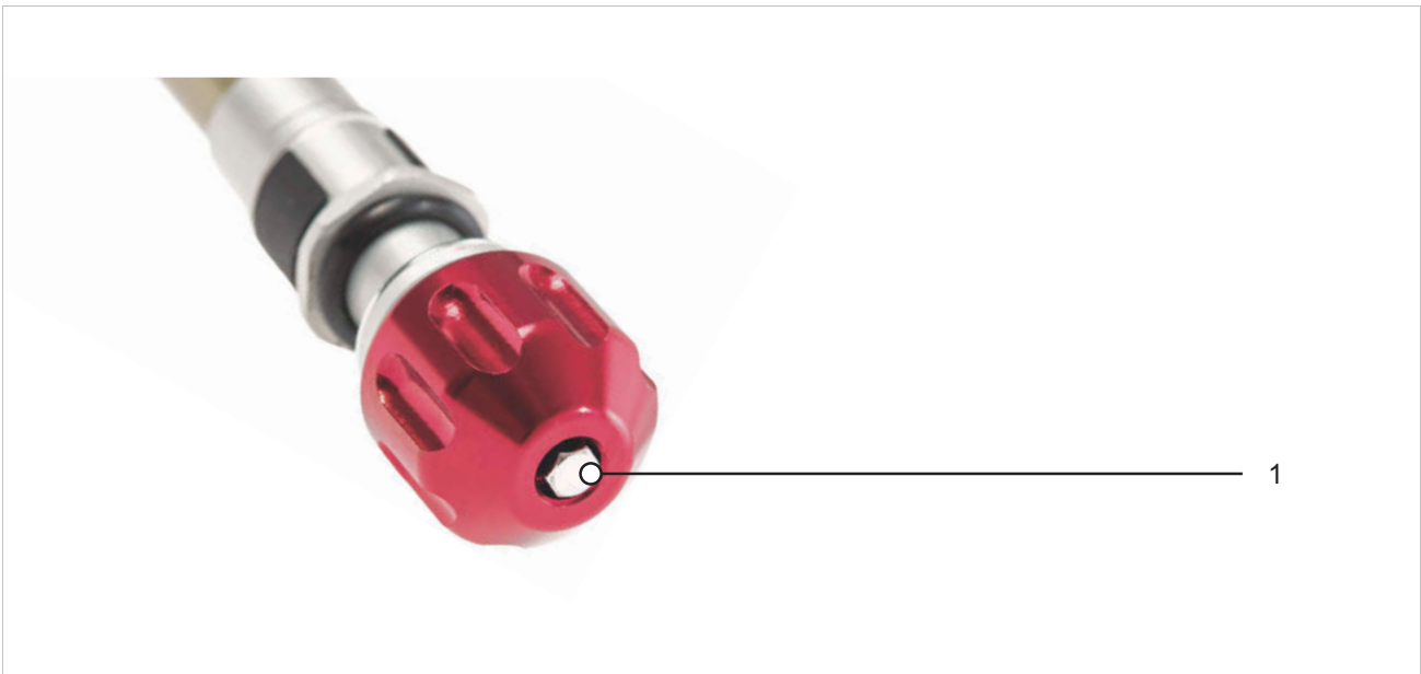
218. ábra: Példa: SR SUNTOUR húzófokozat-beállító (villa) (1)
