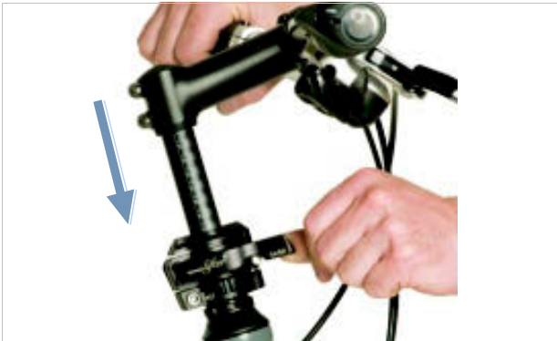
175. ábra: A magasság állítása
