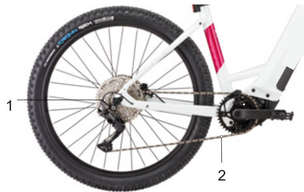
Illustration 18 : Schéma de l'entraînement à chaîne avec dérailleur
