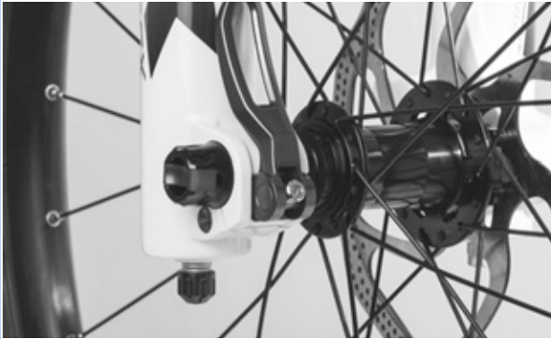
Illustration 95 : Régler la force de serrage de l'attache rapide
