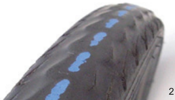
Illustration 85 : Pneu sans profil pouvant être changé (1) et pneu avec bande de protection visible (2) devant être changé
