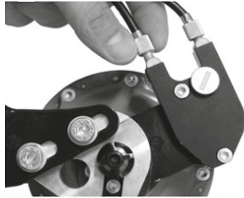
Illustration 91 : Sur les versions de moyeux ROHLOFF avec commande externe du changement de vitesse, le dispositif de réglage de la tension est situé sur le boîtier de câbles qui est placé sur le côté gauche.
