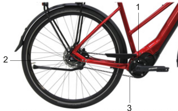
Illustration 19 : Schéma de l'entraînement à courroie
