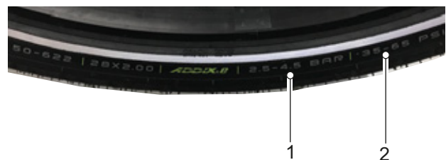
Illustration 84 : Pression des pneus en bar (1) et psi (2)
