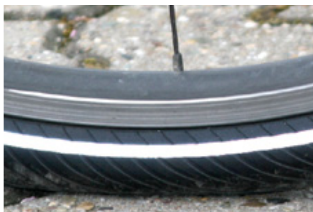
Illustration 57 : Pression correcte. Le pneu se déforme à peine sous le poids du corps.
