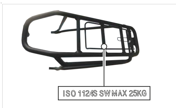
Figur 104: Bagagebærerens maksimale bæreevne (1) er angivet på bagagebæreren
