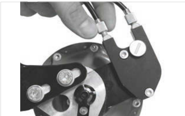
Figur 140: På udgaver af ROHLOFF-nav med ekstern skifteaktivering sidder kabelindstilleren på wireboksen, som sidder på venstre side
