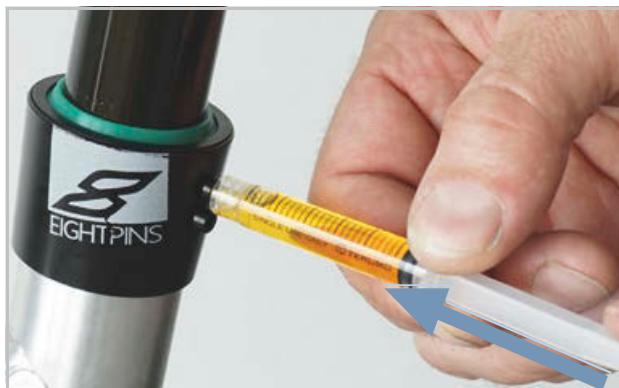
Figur 121: Smøring af eightpins-sadelpind
