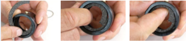
Illustration 113 : Insérer l'anneau de feutre
