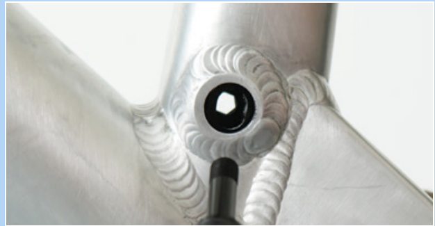
Illustration 160 : Trou de l'interface Postpin
