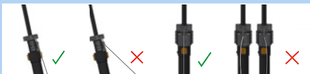
Illustration 127 : Câble Bowden correct et incorrect
