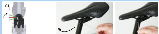
Illustration 137 : Fermer le réglage de la hauteur
