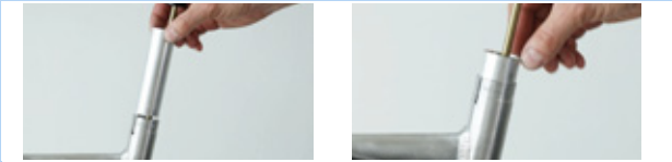
Illustration 131 : Insérer le tube de la douille de glissement dans le tube de selle
