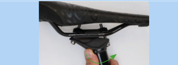
Illustration 151 : Ouvrir le réglage de la hauteur
